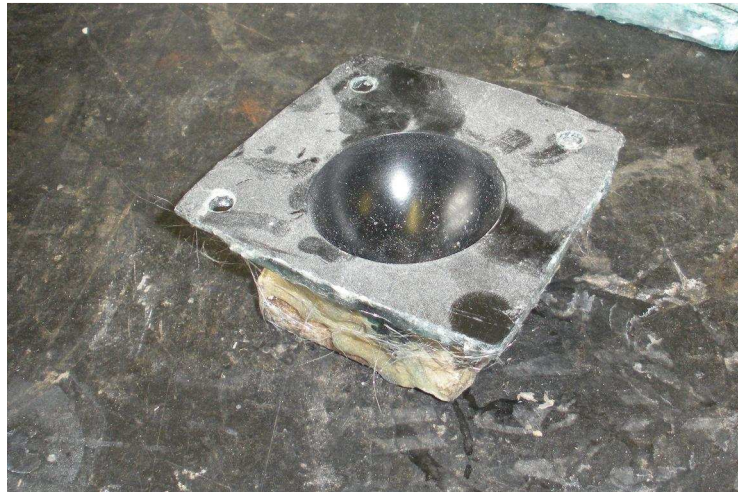
Obr. 18. Třetí část formy pro výrobu polokulové skořepiny, tvořící hlavu madla
