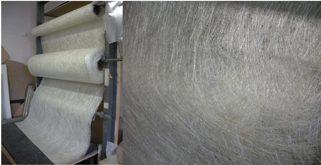
Obr. 16. Role tkaniny ze skelného vlákna, vpravo detail tkaniny
