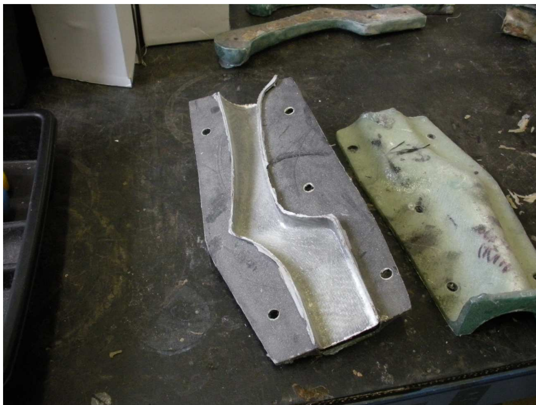
Obr. 21. Výrobek z již vytvrzeného kompozitu ve formě
