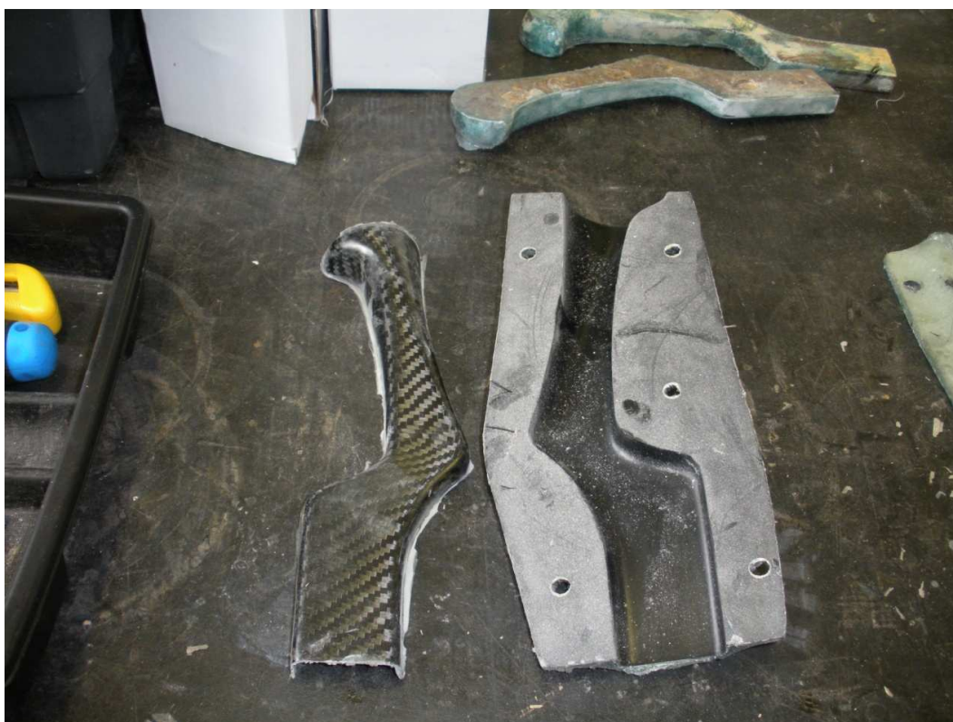
Obr. 22. Výrobek vyjmutý z formy
