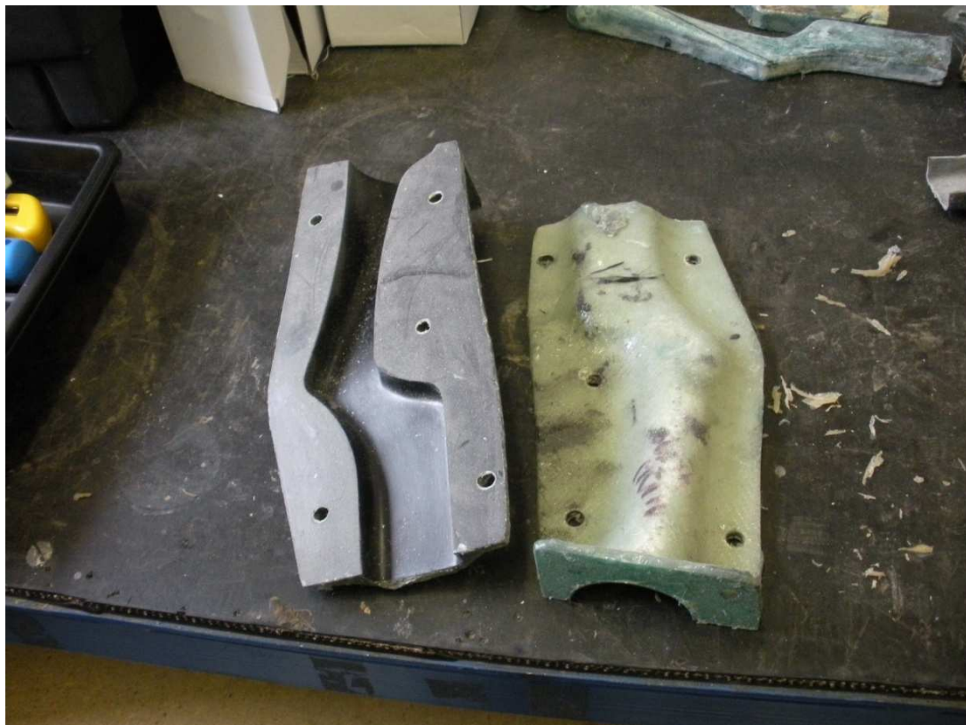
Obr. 17. Dvě části formy, nalevo vnitřní a napravo vnější část-viditelná hrana potřebná k přesnému a jednoduchému zařezání skořepiny, které je nutné pro dokonalé lícování při lepení.
