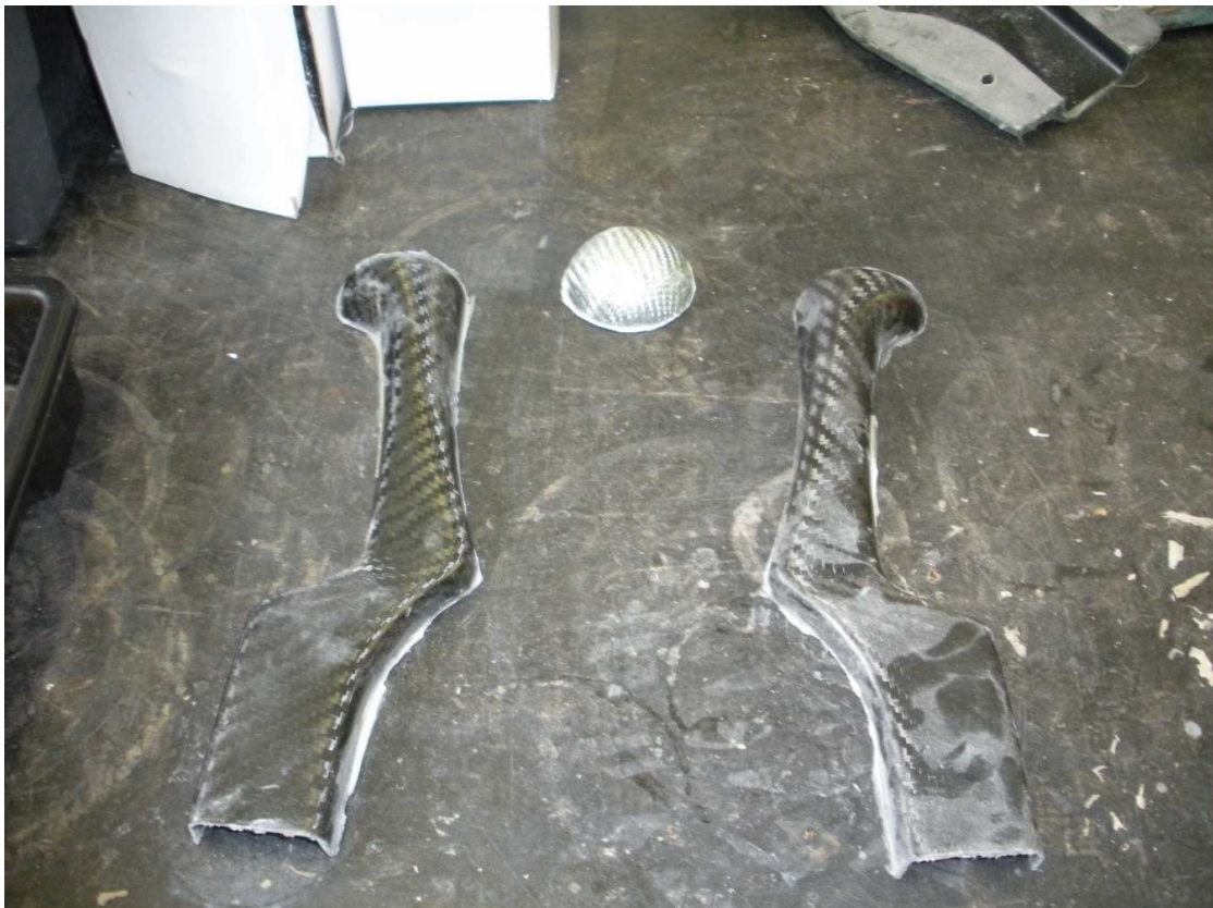
Obr. 25. Všechny části výrobku před opracováním pro lepení
