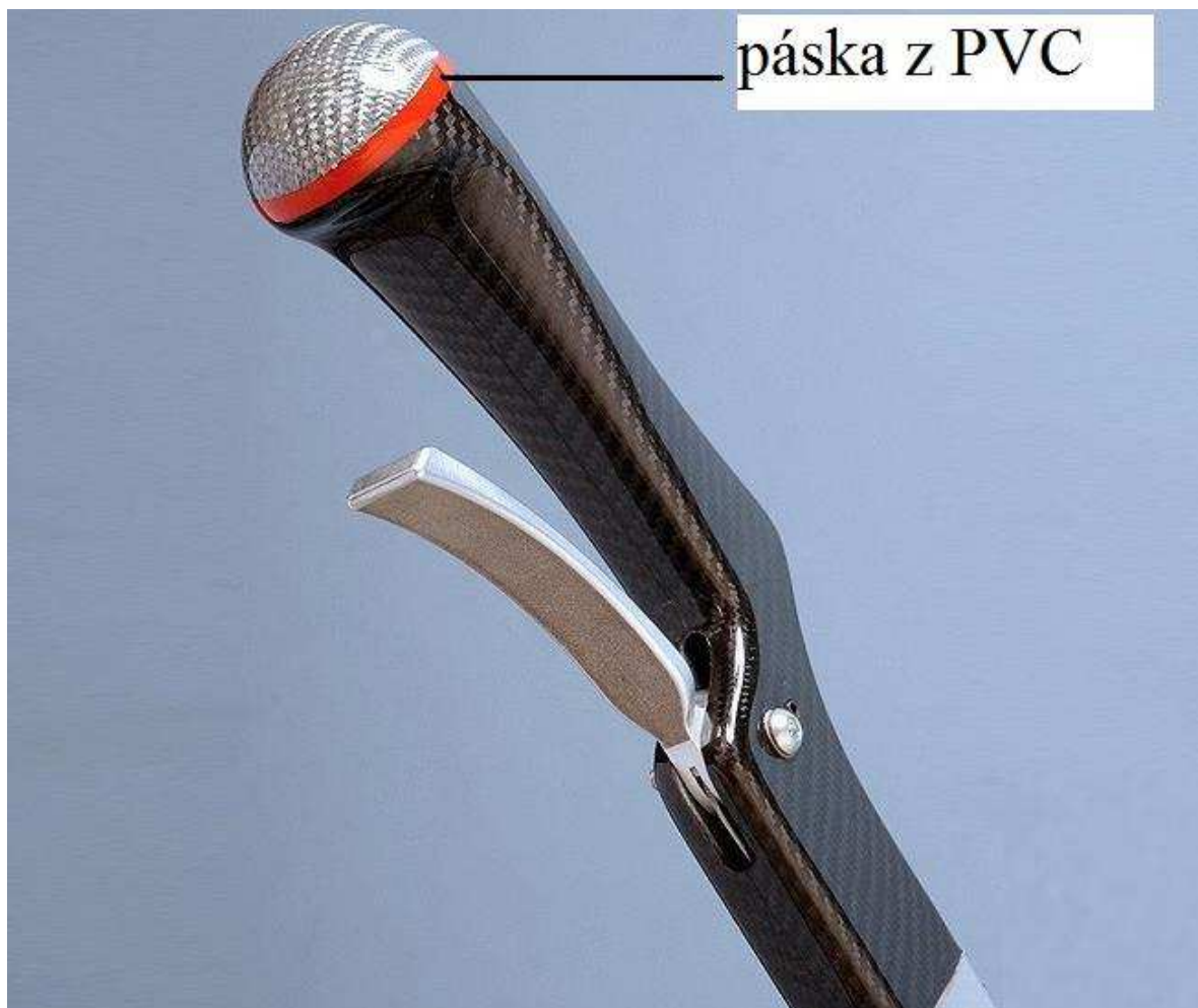
Obr. 28. Zkompletovaná řadicí páka i s páčkou na ovládání spojky
