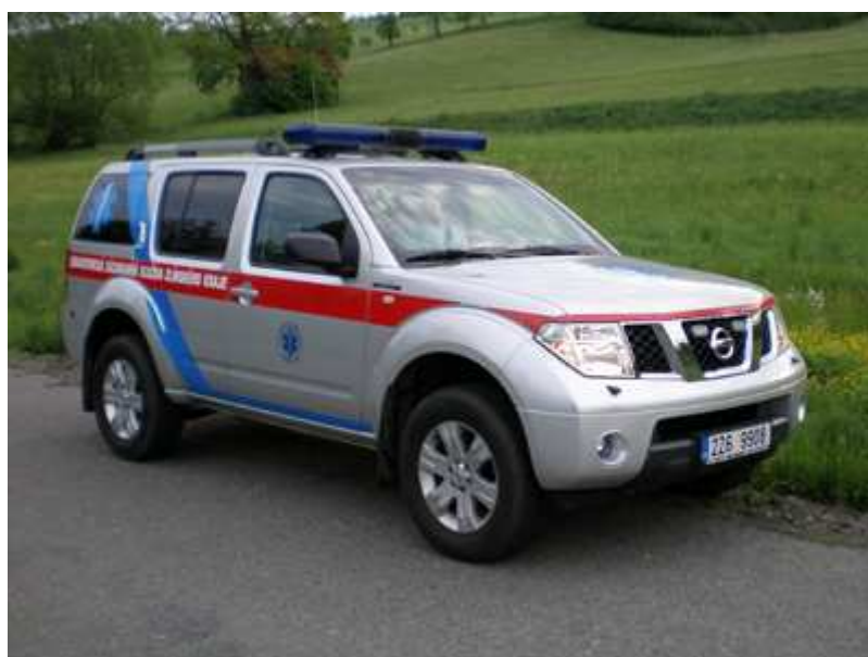
Nissan Pathfinder 2,5 DCI - vozidlo určeno pro výjezdy v režimu RV a pro zásah v těžce přístupném terénu. Vnitřní zástavba je provedena tak, aby bylo možné v případě potřeby transportovat jednu ležící osobu.
