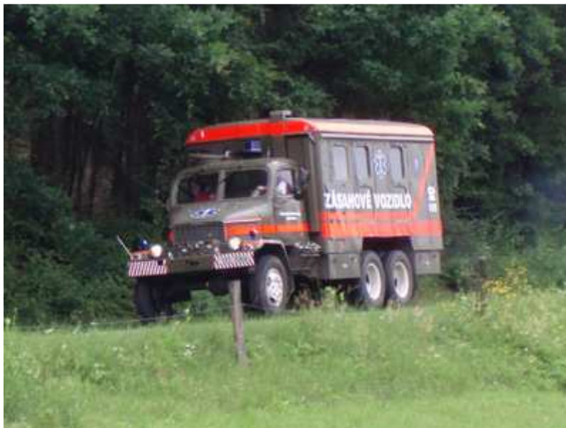
Zásahové vozidlo Praga V3S, Podvozek PV3S zajišťuje dostatečnou průchodnost terénem.
