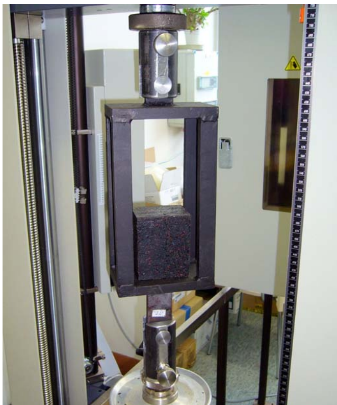
Obr. 21 Zkušební přípravek na trhacím stroji
