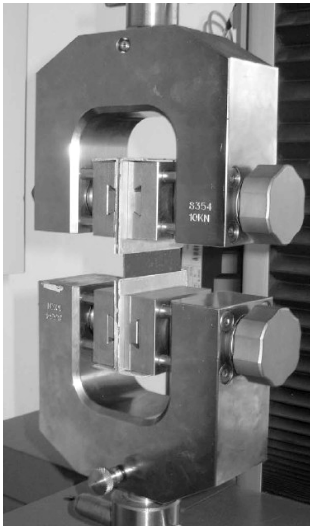
Obr. 15 Upínací zařízení pro měření čistého smyku [2]
