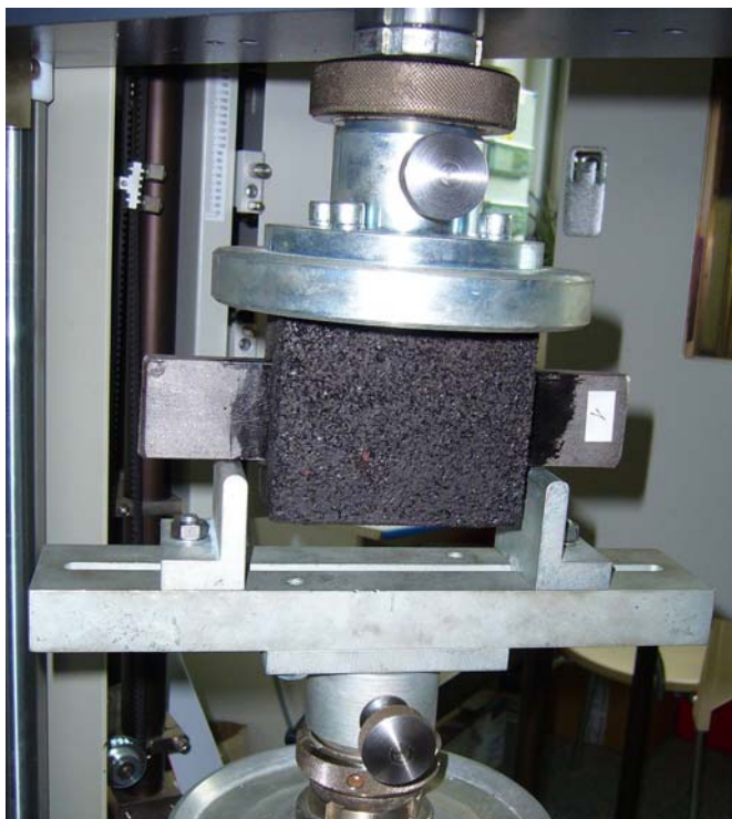
Obr. 42 Tlaková zkouška na trhacím stroji
