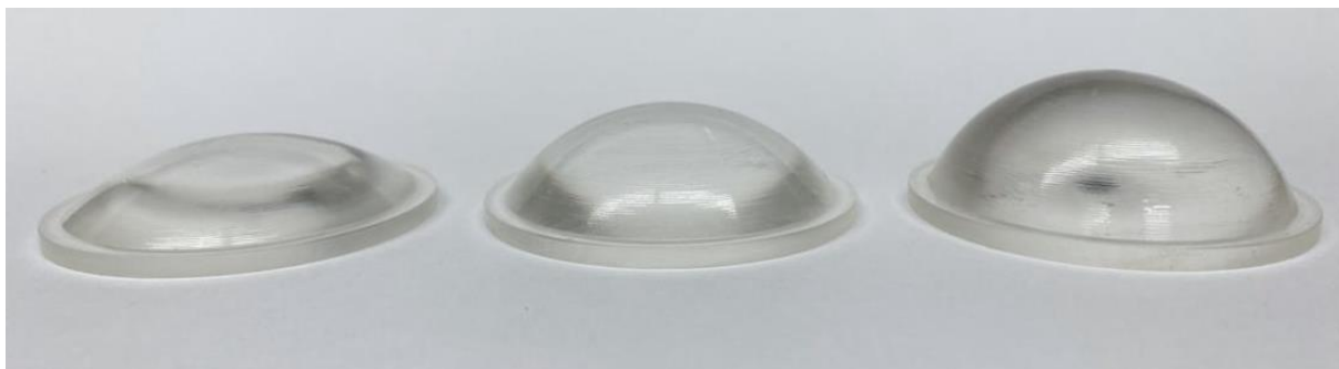
Obr. 2.6: Vyrobené čočky o tloušťce 12,5 mm, 16,5 mm a 20,5 mm bez zjevných vad
