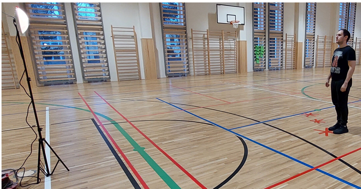
Obr. č. 54 Tretí test merania detekčnej charakteristiky druhého PIR svietidla [vlastný]
