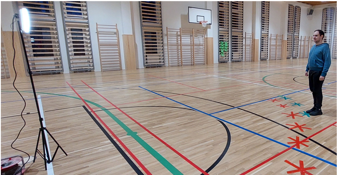
Obr. č. 60 Tretí test merania detekčnej charakteristiky MW svietidla [vlastný]
