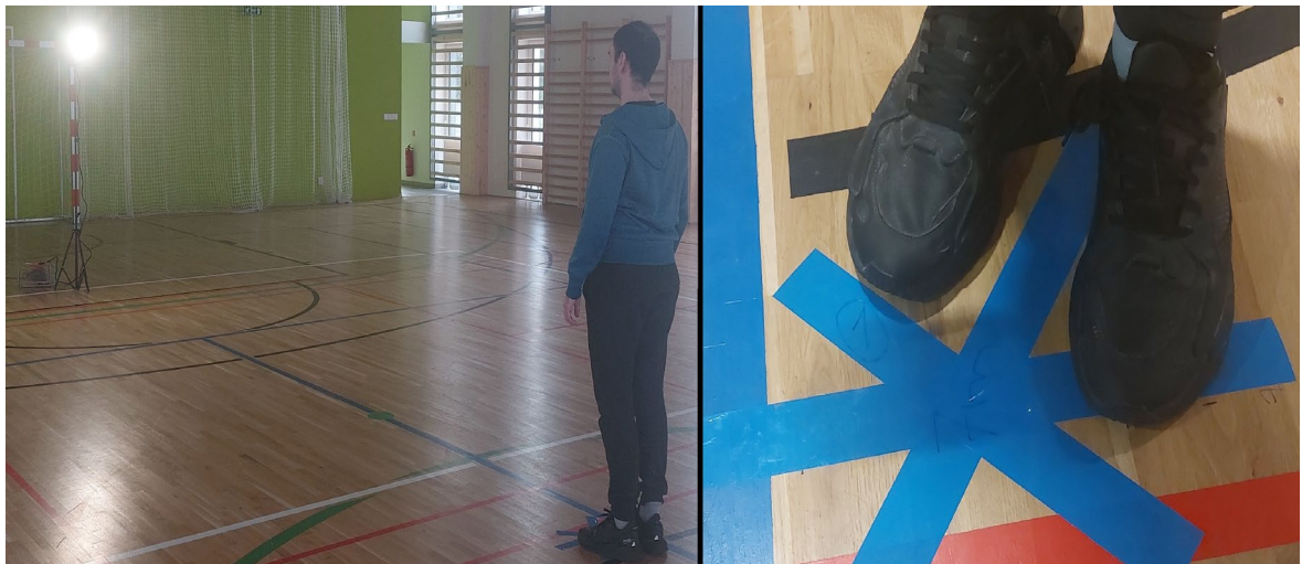
Obr. č. 46 Prvý test merania detekčnej charakteristiky PIR svietidla [vlastný]
