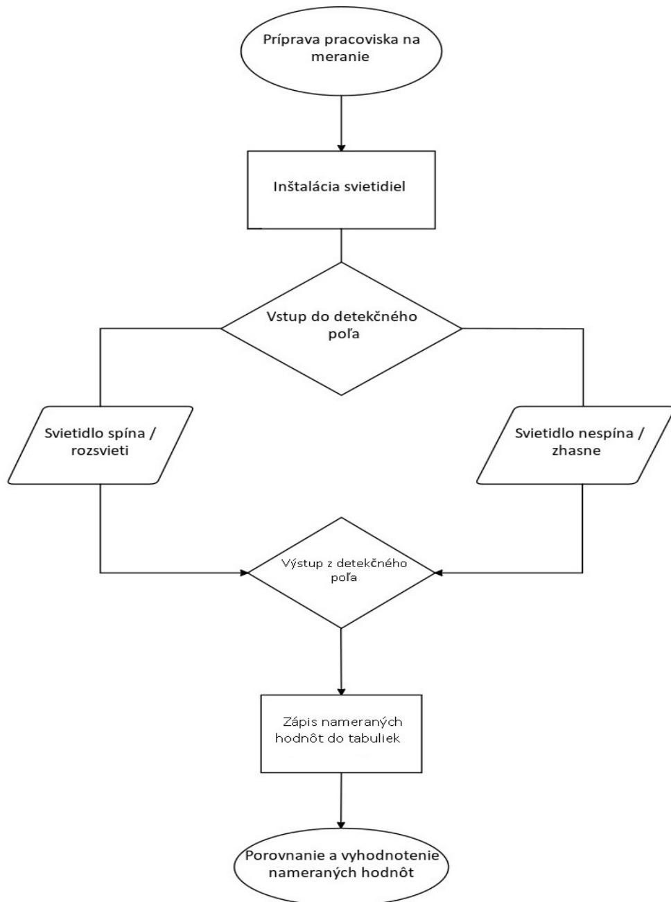
Obr. č. 42 Vývojový diagram merania [vlastný]
