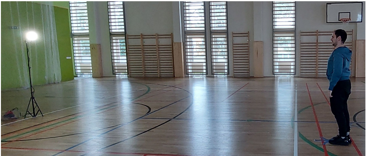
Obr. č. 47 Druhý test merania detekčnej charakteristiky PIR svietidla [vlastný]
