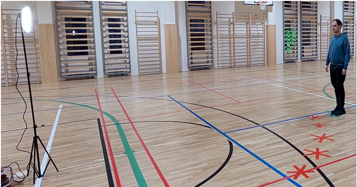
Obr. č. 58 Prvý test merania detekčnej charakteristiky MW svietidla [vlastný]
