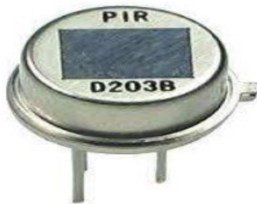
Obr. č. 26 PIR senzor, základ PIR detektora [22]
