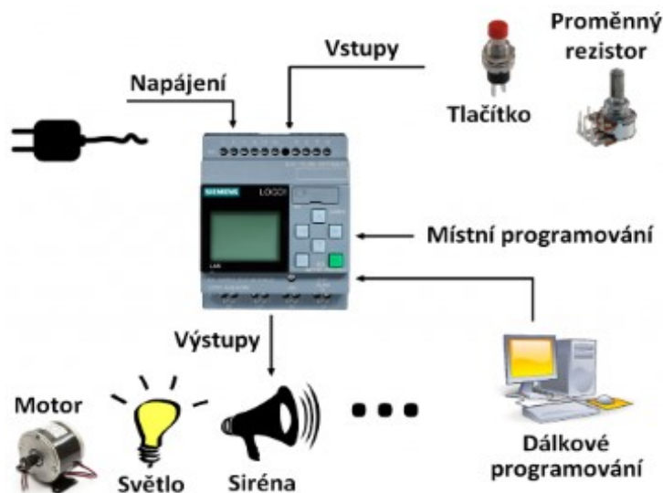
Obrázek 28 Propojení PLC s dalšími zařízeními [44]
