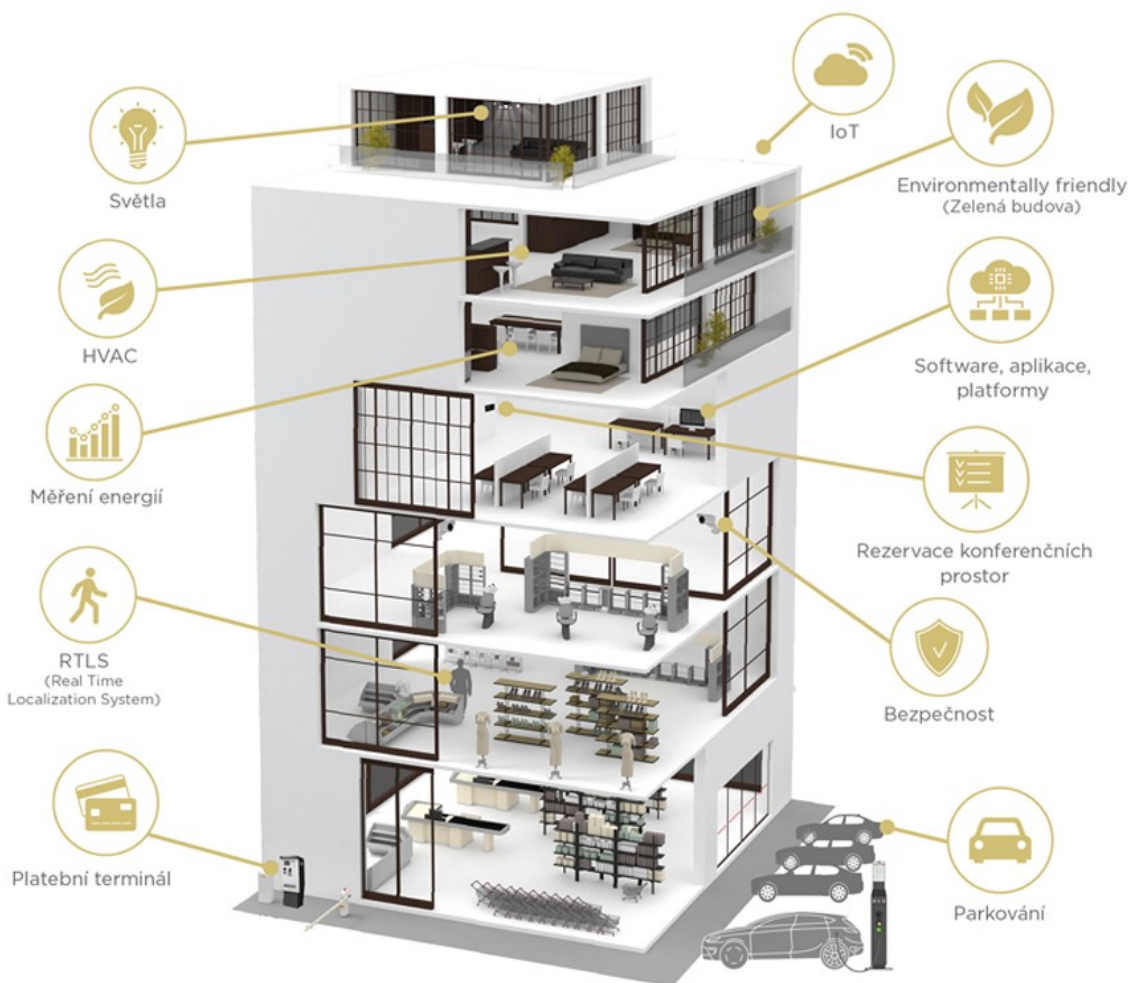
Obrázek 55 Systém řízení budovy [82]
