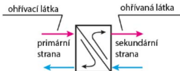
Obrázek 25 Princip výměníku tepla [38]
