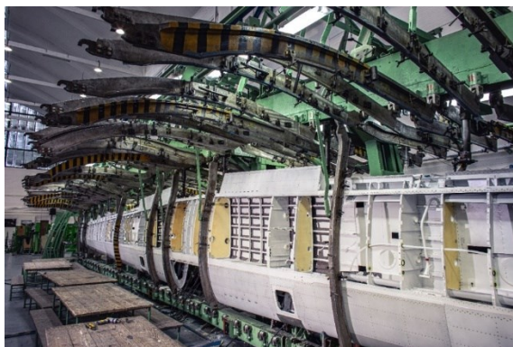
Obrázek 8 Nýtovací přípravek pro sestavu (Aircraft Industries, © 2023)
