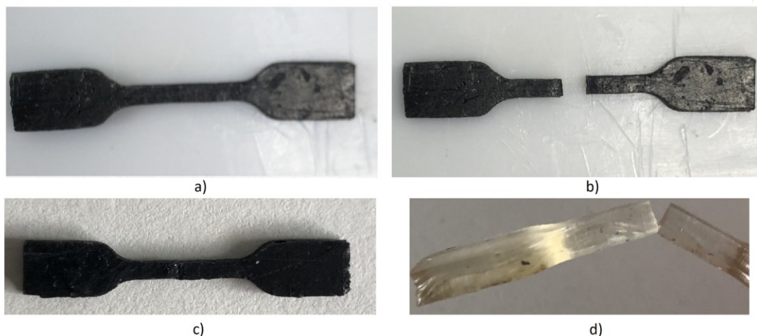
Obrázek 43: a) vzorek kompozitu SBS a GO před oddělením; b) tentýž vzorek po rozdělení; c) vzorek kompozitu SBS a GO po přiložení a 168 hodinách; d) vzorek čistého SBS, kde spojení proběhlo pouze ve spodní části vzorku
