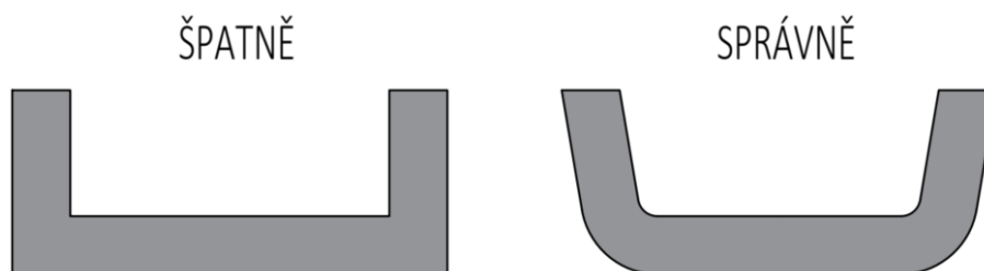
Obr. 11 Správně navržený výrobek s úkosem [19]
