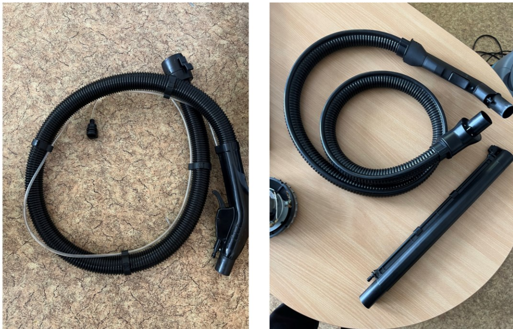
Obrázek 26: Hadice s volnou a integrovanou trubicí na saponát
