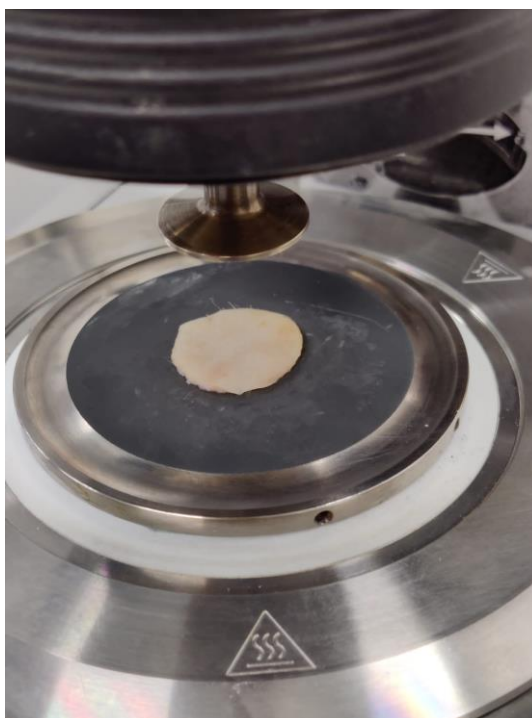
Obrázek 16 Vzorek prasečí kůže umístěný mezi geometriemi reometru.
