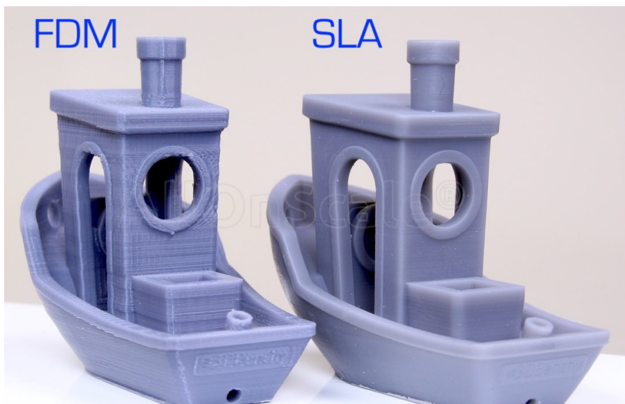
Obrázek 17: Porovnání kvality 3D modelu vytištěného metodami FDM a SLA [44]
