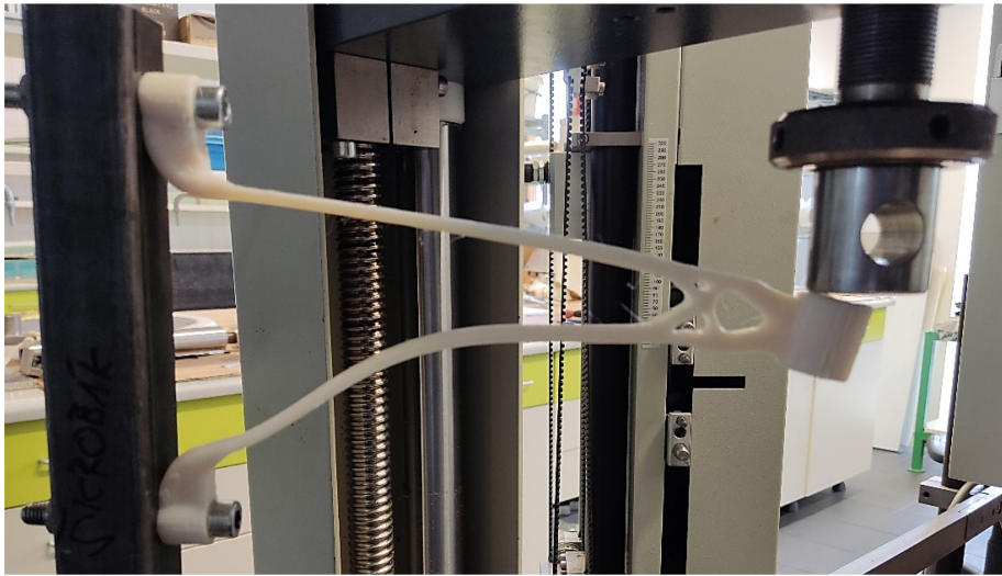
Obrázek 81: Mechanická zkouška součásti z materiálu PC s 84% odlehčením
