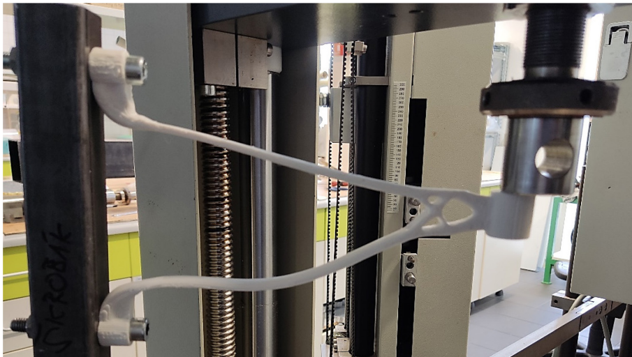
Obrázek 80: Mechanická zkouška součásti z materiálu ASA s 85% odlehčením
