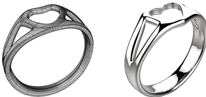
Obrázek 3: Modelování prstenu metodou T-Spline a jeho vyrenderování [9]
