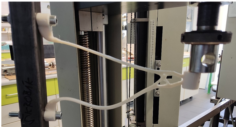
Obrázek 82: Mechanická zkouška součásti z materiálu PC s 89% odlehčením
