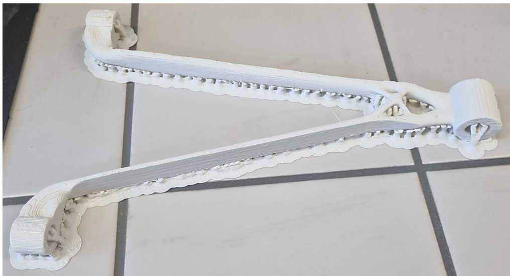
Obrázek 73: Součást z materiálu ASA s 85% redukcí hmotnosti materiálu po 3D tisku
