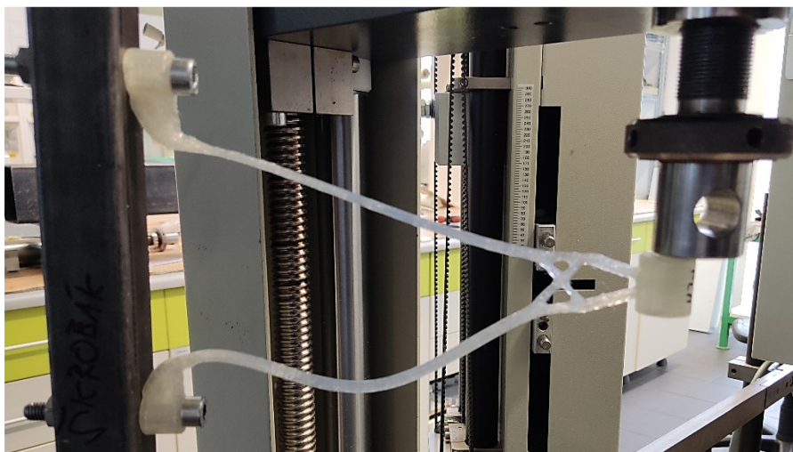
Obrázek 78: Mechanická zkouška součásti z materiálu PLA s 90% odlehčením
