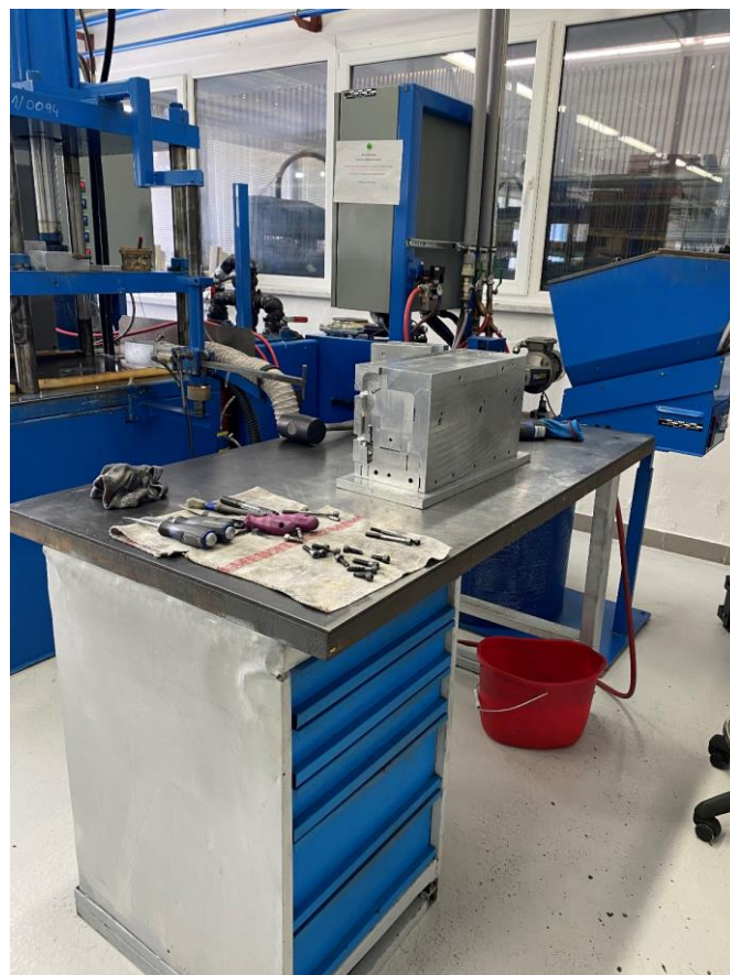
Obrázek 17: Lis na výrobu voskových modelů. Zdroj: vlastní
