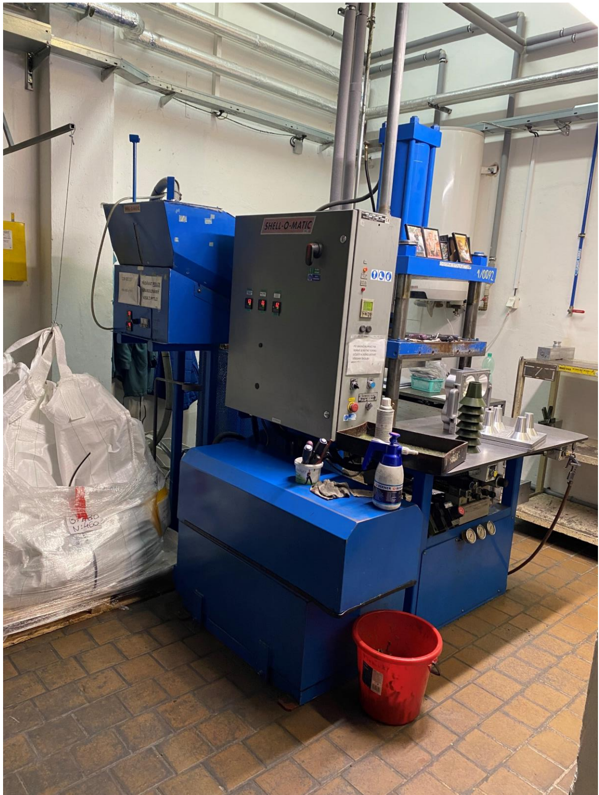
Obrázek 18: Lis na výrobu vtokových soustav ve skladu forem. Zdroj: vlastní
