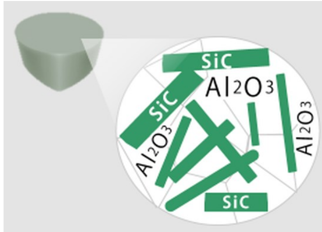
Obr. 24 Diagram složení keramiky na bázi Whiskerů [33]
