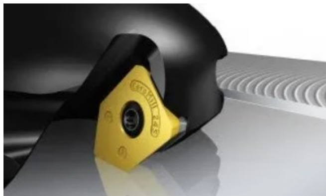
Obr. 3 Dokončování hladicími břitovými destičkami [6]
