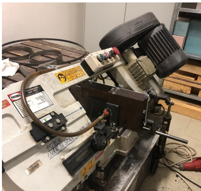
Obr. 42 Pásová pila PPK-175 T při řezání vstupního materiálu
