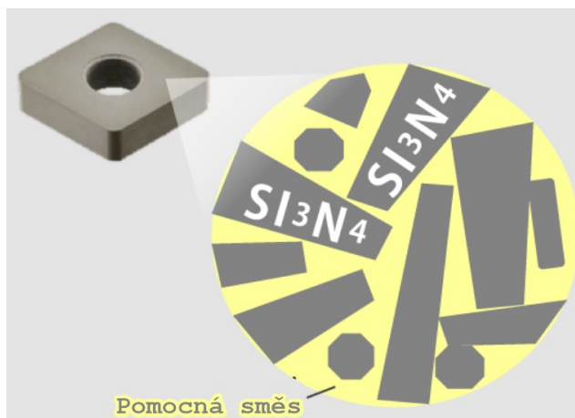
Obr. 25 Diagram složení keramiky na bázi nitridu křemíku [33]
