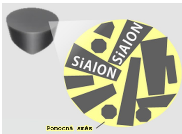
Obr. 26 Diagram složení Sialonu [33]
