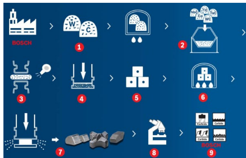
Obr. 20 Schéma výroby SK [26]
