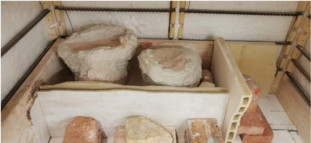
Obr. 23: Umístění forem do elektrické komorové pece
