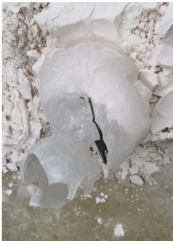
Obr. 24: Čištění hlavy od sádry
