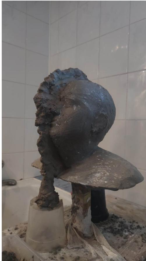
Obr. 15: Hlava z šedé el. sádry s dělicí rovinou pro odlévání formy
