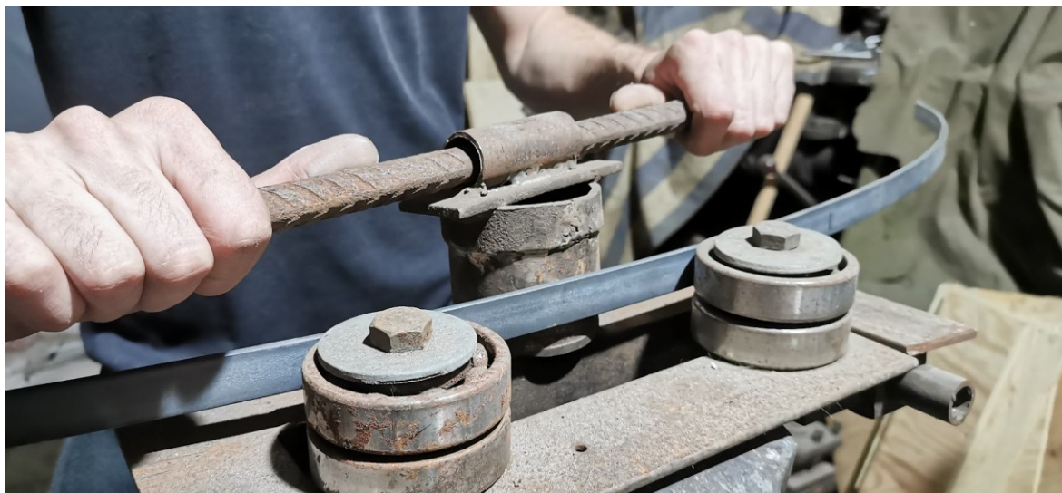
Obr. 30: Ohýbání pásoviny 20 x 5 mm
