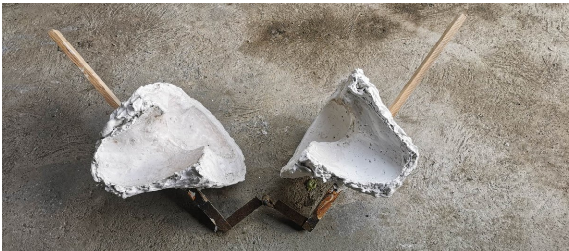
Obr. 17: Forma s ocelovými panty pro hutní foukání skla
