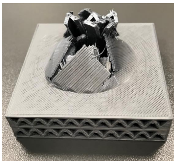
Obr. 14: Delaminace jednotlivých struktur s průchozími otvory
