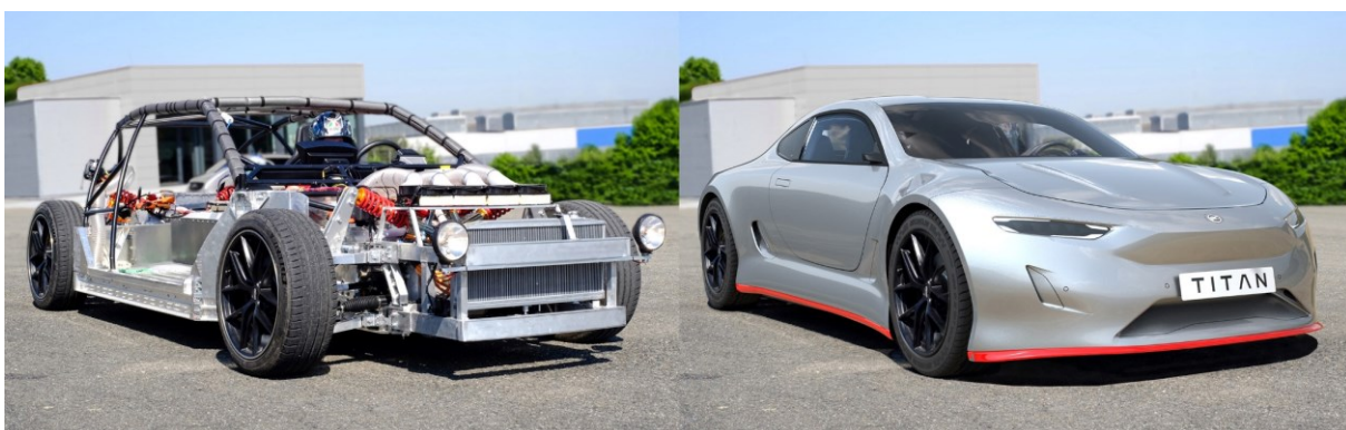
Obr. 75: Pojízdná podvozková platforma Titan vyvinutá na VŠB-Technické univerzitě Ostrava a vizualizace karoserie určená pro podvozkovou platformu.
