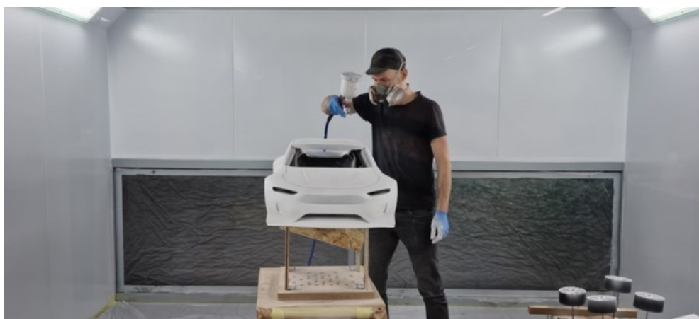
Obr. 106: Lakování makety modelu Titan 1:4 - nástřik bílý plnič
