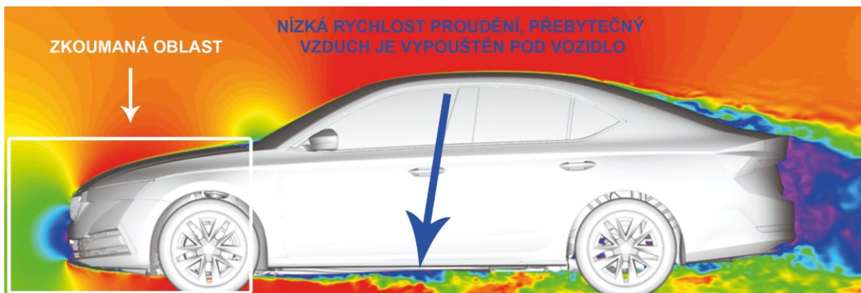
Obr. 71: Simulace proudění vzduchu kolem vozu Škoda Octavia IV [58] upraveno
