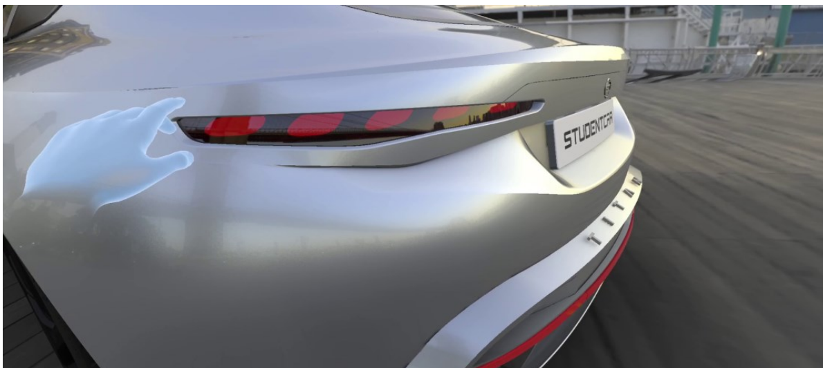
Obr. 49: Virtuální projekce karoserie v reálné velikosti zobrazuje velikost svítlen vůči lidské ruce
