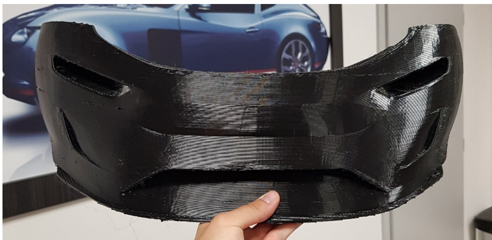
Obr. 104: První velkoformátový 3D tisk -přední nárazník (PET)
