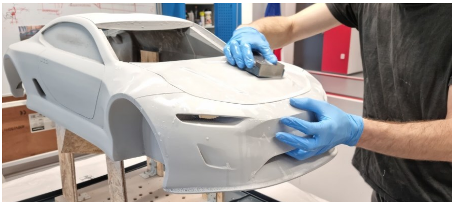
Obr. 108: Lakování makety modelu Titan 1:4 vybrušování ploch pod vodou
