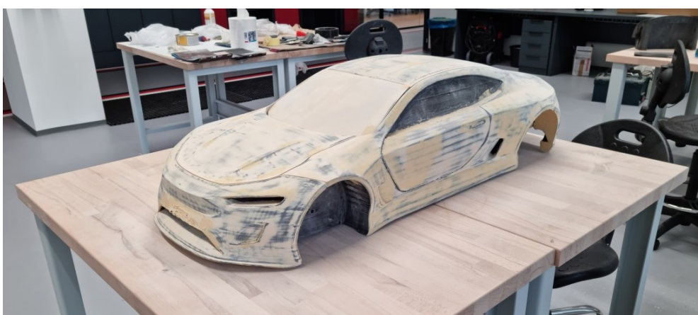
Obr. 105: Vybroušení první vrstvy polyesterového tmelu
