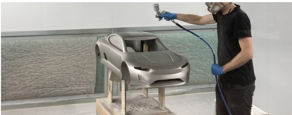
Obr. 109: Lakování makety modelu Titan 1:4 stříbrný lak
