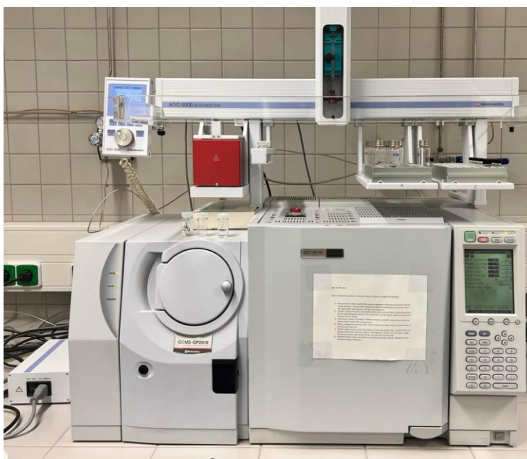
Obrázek 23 Plynový chromatograf s hmotnostním detektorem GCMS-QP2010 SE Shimadzu
