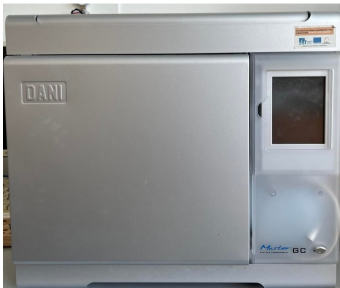
Obrázek 16 Plynový chromatograf DANİ Master GC Fast Gas Chromatograph s detektorem FID
