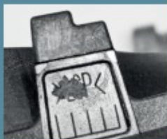
výlisk z formy bez povlaku s vytržením materiálu
