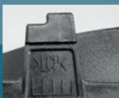
výlisk z formy s povlakem SIGAAN Px bez vytržení materiálu
