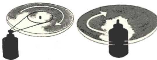
Obr. 09. Řemíkový a přímý náhon gramofonu [27]
