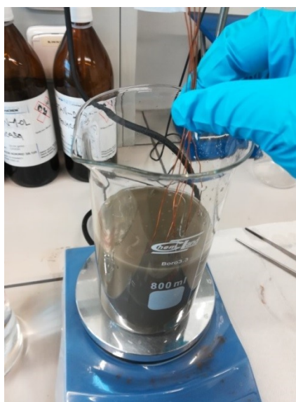
Obrázek 28 Syntéza částic stříbra na povrch nanovlákněné textilie
