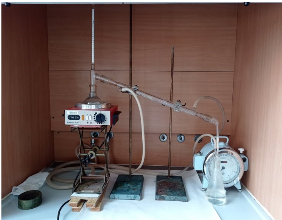
Obr. č. 16 Konstrukce plynové aparatury s budíkem [36]
