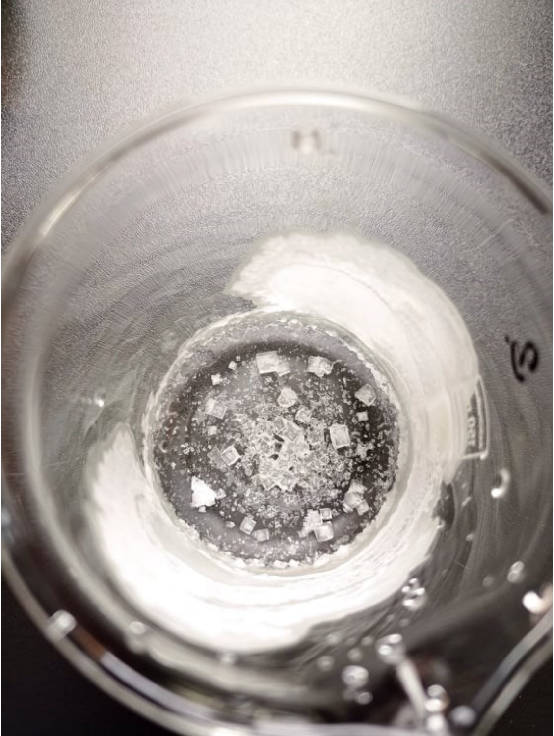
Obr. č. 17 Vysrážené tavící soli ve skleněné kádince z filtrátu solné strusky [36]
