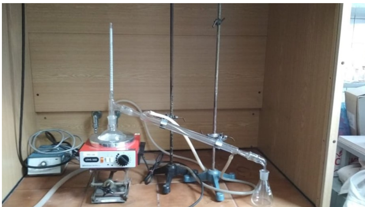
Obr. č. 15 Konstrukce destilační aparatury [36]
