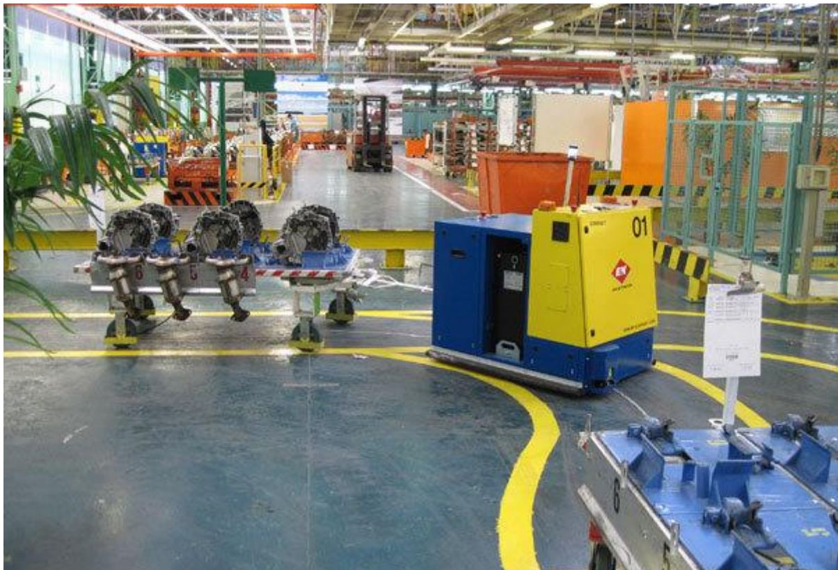
Obr. 2 Príklad AGV systém v rámci zásobovacieho procesu [2].
