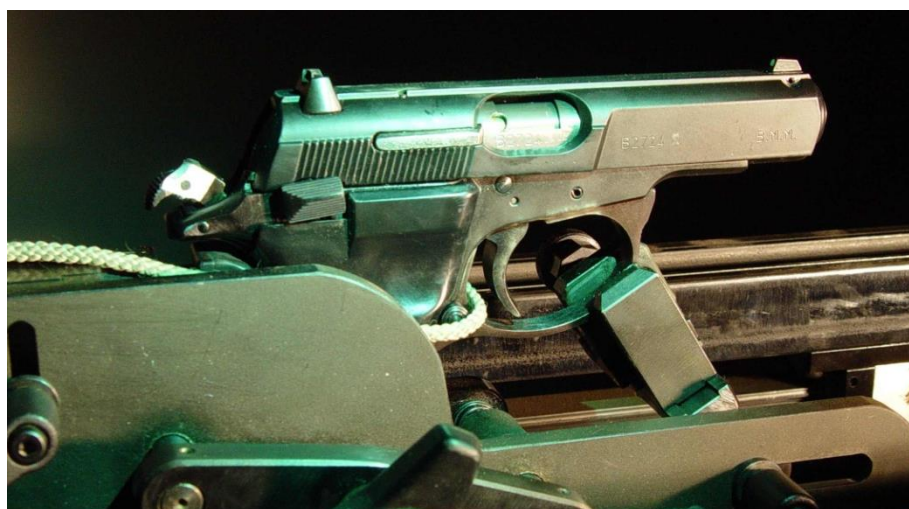
Obrázek 5 Pohled na nabitou zbraň v univerzální střelecké stoličce při střeleckém experimentu (Prototypa Brno, a.s.). Zdroj: fotoarchiv autorů.
