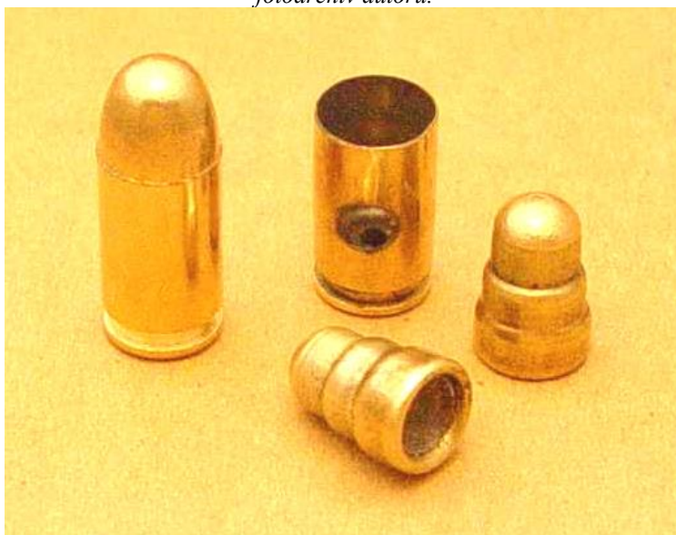
Obrázek 7 Náboj 9 mm Browning court. Vlevo - náboj před výstřelem, vpravo - vystřelená nábojnice s kruhovým otvorem v plášti a dvě stupňovitě deformované střely po vyjmutí z vývrtnu hlavně. Zdroj: fotoarchiv autorů
