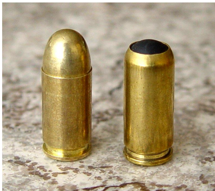
Obrázek 2 Náboje 9 mm Browning court (vlevo) a 9 mm PA Rubber (vpravo). Zdroj: fotoarchiv autorů.
