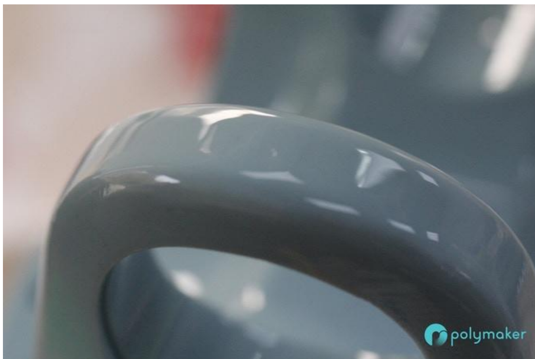
Obr. 26: Detail povrchově upraveného 3D tisku v Polysheru. https://www.kickstarter.com
