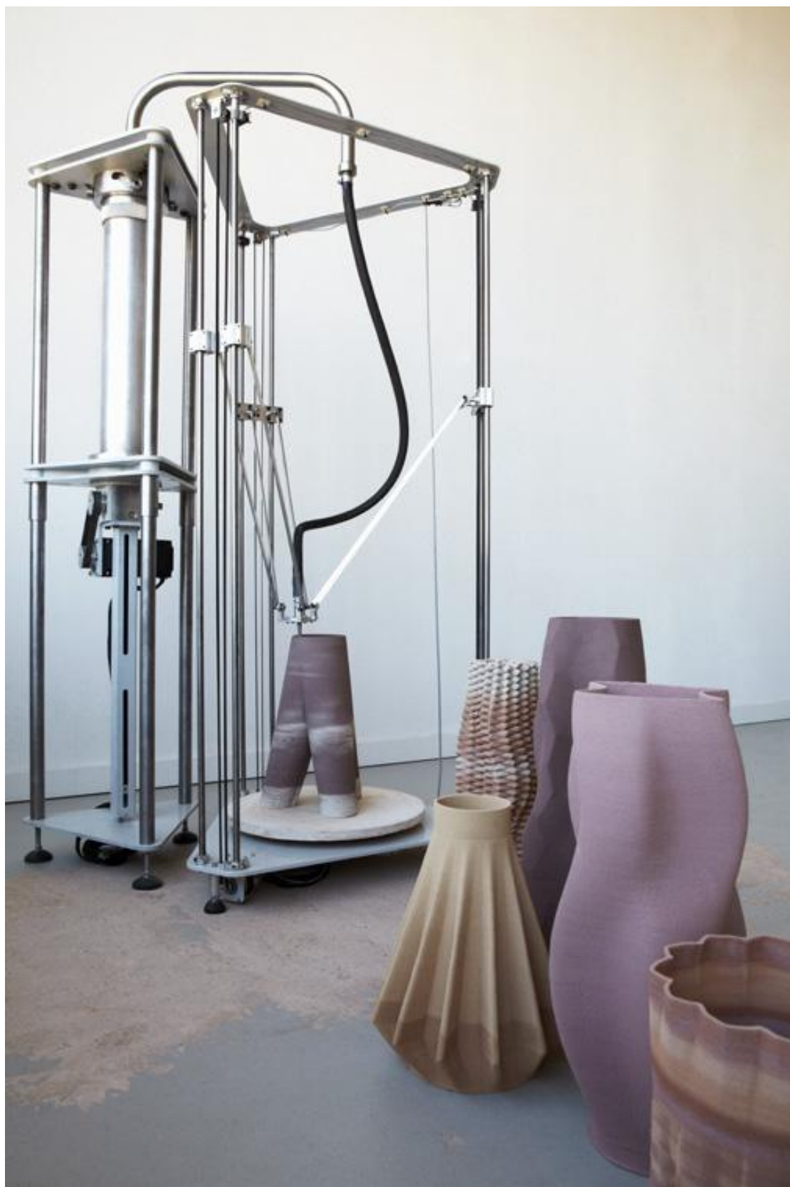
Obr. 44: 3D tiskárna zkonstruovaná Oliverem van Herptem www.oliviervanherpt.com
