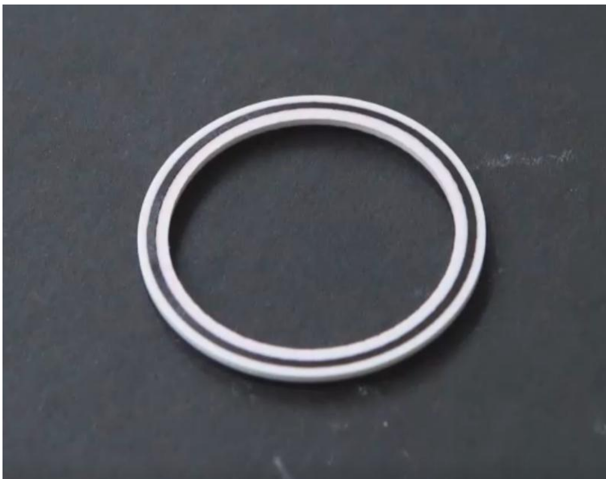
Obr. 67: Multimateriálový kompozit – finální vzorek bílého a černého oxid zirkoničitý souběžně tištěného za pomoci 3D tisku metodou FDM. www.jove.com
