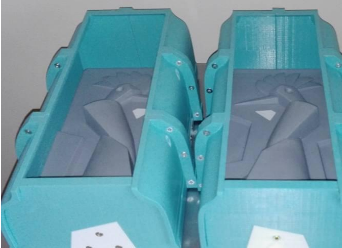
Obr. 89: Dudek - první komplexní rozmnožovací zařízení pro výrobu sádrových produkčních forem. Archiv Futuree
