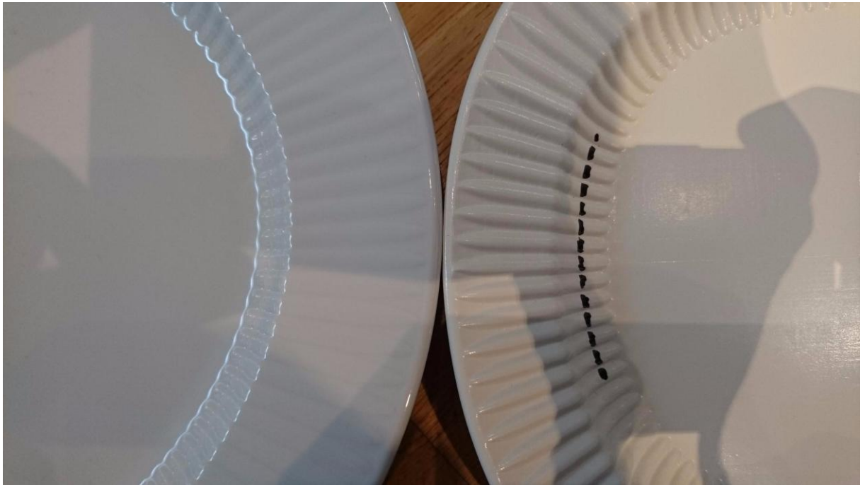
Obr. 17: Korekce proporční chyby reliéfu oválu Legio dánského studia Eva Solo vyvíjeného společností Thun 1794.
