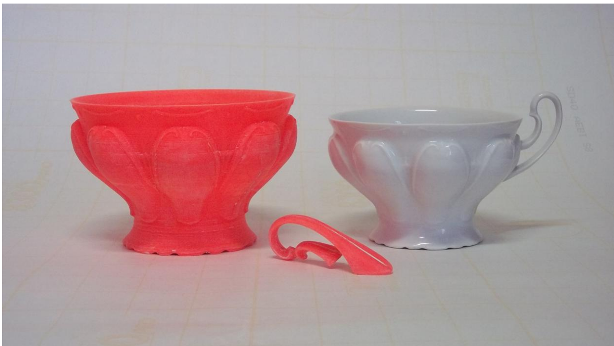
Obr. 75: Tisknutý model a porcelánový prototyp repliky barokního šálku Queen Archiv Futuree
