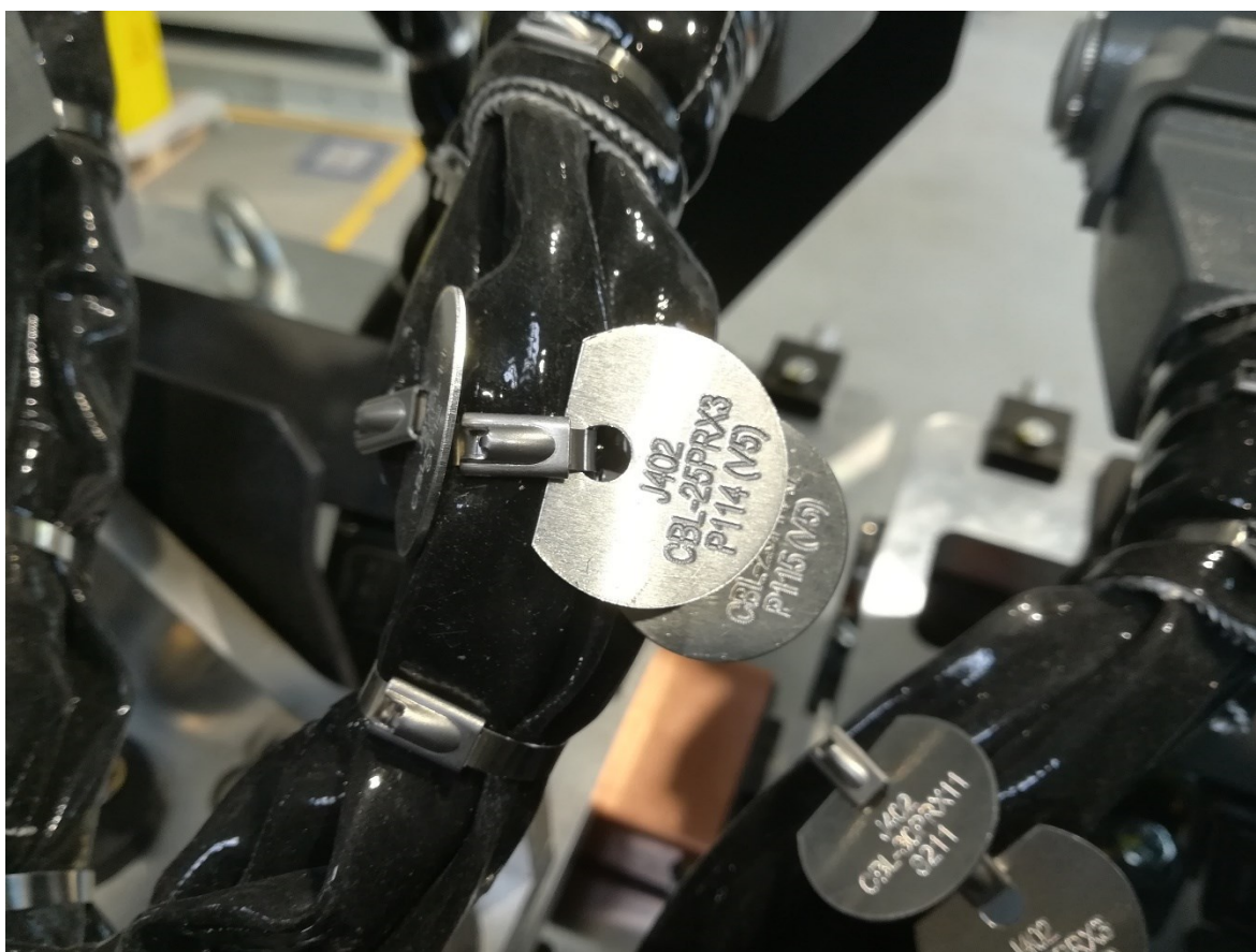
Obr. 10. Označení kabelů pomocí hliníkových štítků
