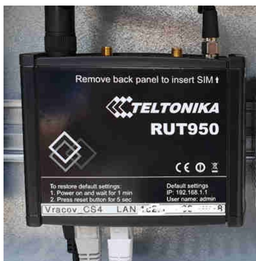
Obr. 8.12 LTE router RUT 950 v rozvaděči [10]
