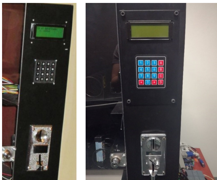
Obr. 19 Keypad a PLC (původní model vlevo)
