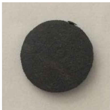
Obrázek 25 Vylisovaný a vyseknutý vzorek EPDM
