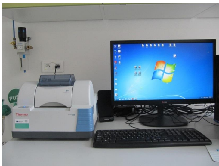
Obr. 20 Prístroj NICOLET iS5 s iD1 transmission od firmy Thermo Scientific [98]
