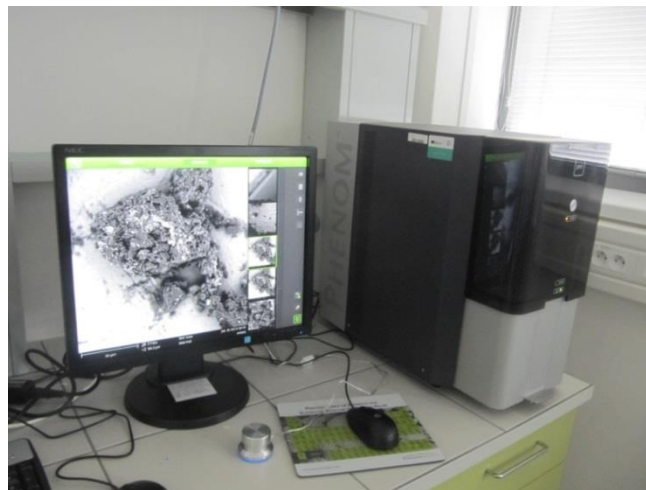
Obr. 21 Stolné zobrazovacie zariadenie – skenovací elektrónový mikroskop Phenom Pro [98]
