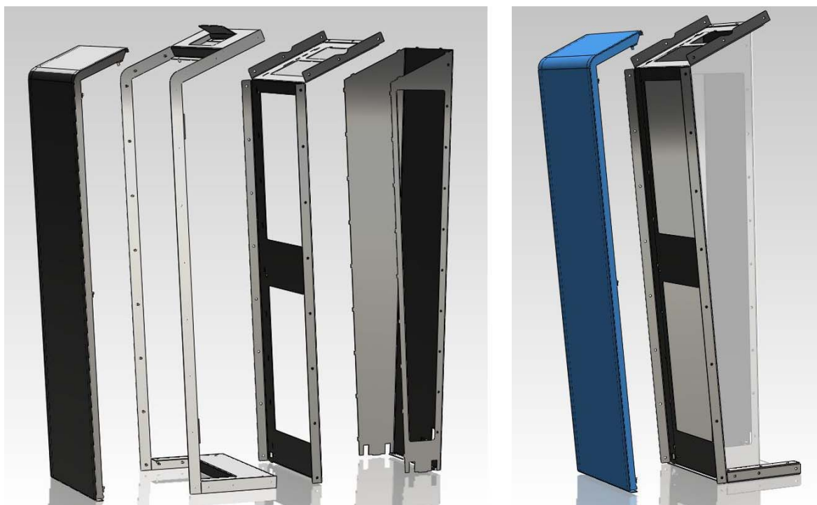
Obrázek 45. Přední kryt jako odnímatelný díl
