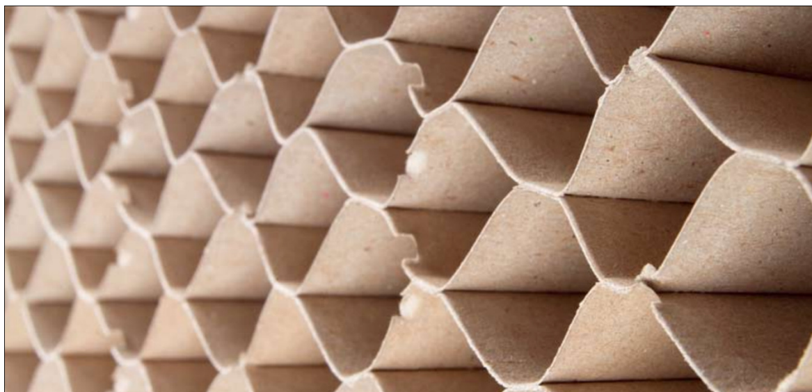
Obrázek 16. Voštinová deska – náhled na charakteristickou voštinovou výplň. Často se výplň přirovnává k včelí plástvi. Tvoří ji řada hexagonálních komůrkových otvorů
