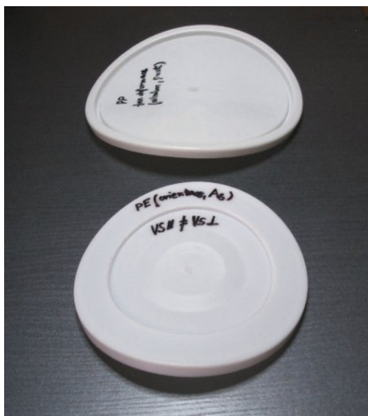
Obr. 20. Deformace víka z PP a PE vlivem anizotropie smrštění jako důsledek rozdílné orientace [12]
