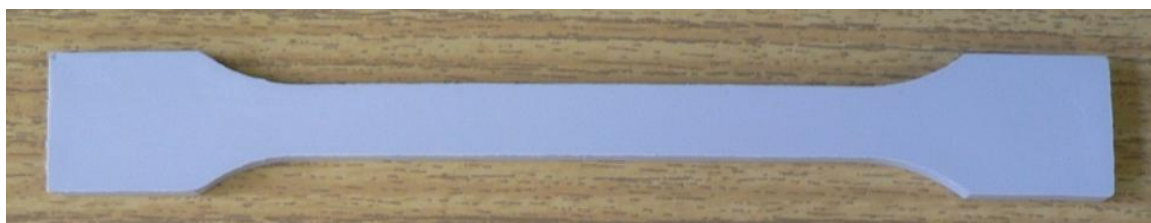
Obr. 19 Zkušební tělísko pro tahovou zkoušku zhotovené firmou Obzor
