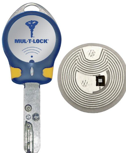
Obr. 5. Synergický duální klíč Interactive CLIQ (Mul-T-Lock, Ltd., 2008)
