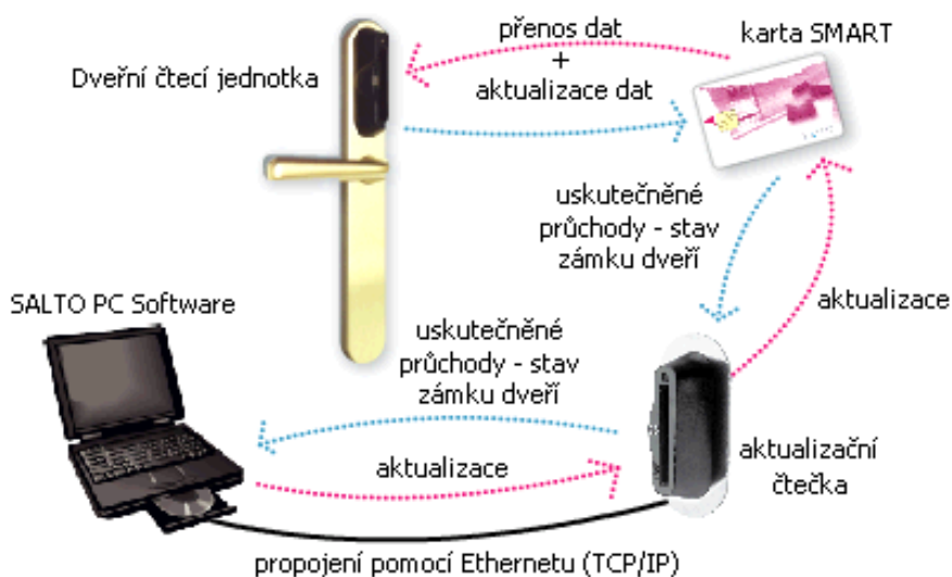
Obr. 18. Schéma virtuální sítě SVN (EVVA, s.r.o. Praha, 2006)
