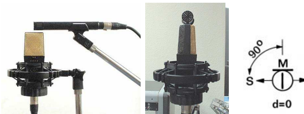
Obr. 18,19,20: Ukázka Systému MS s mikrofony AKG C414X1 (osmička) a Audiotechnica 4051 (kardioida).
