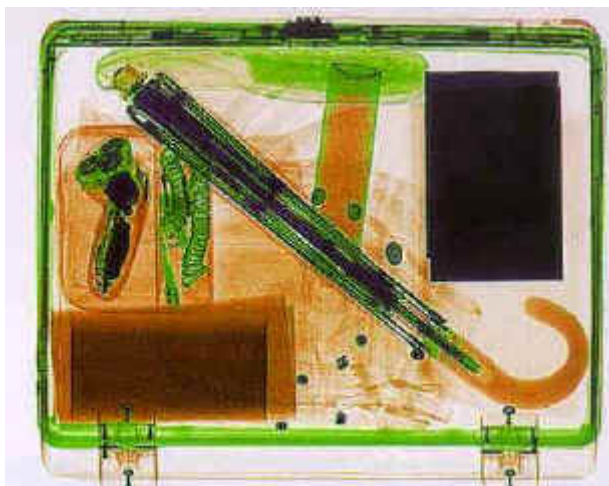
Obrázek 6 Snímek s rozlišením organických a anorganických látek
