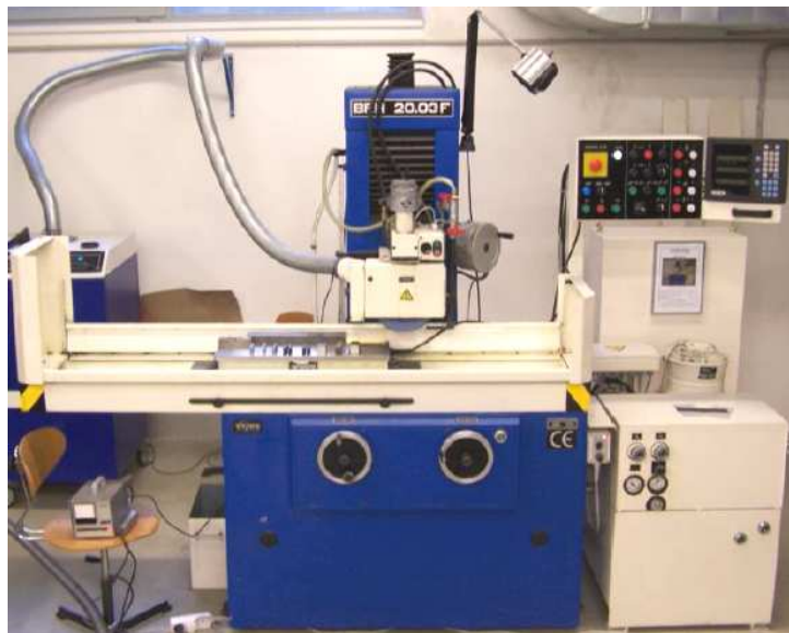
Obr. 27. Rovinná horizontální bruska BHV 20.03F
