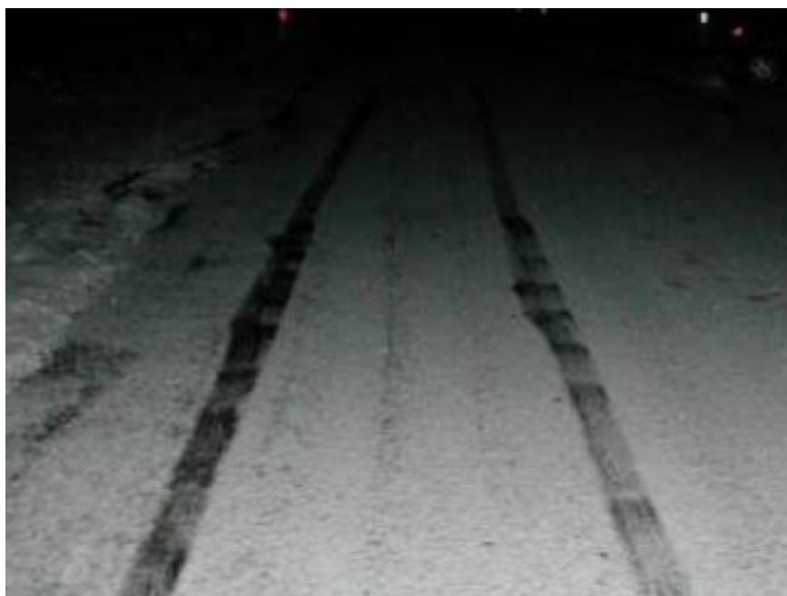
Obr. 20 Stopy brždění vozidla vybaveného systémem ABS
