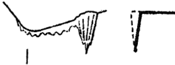
Obr. 16 Opotřebení hřbetu ve tvaru vrubu [1]
