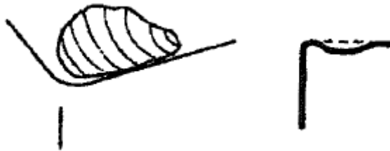
Obr. 14 Opotřebení čela ve tvaru žlábků [1]
