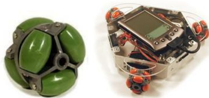
Obrázek 1.9 Detail všesměrového kola (vlevo) a tříkolový robot se všesměrovými koly (vpravo)
