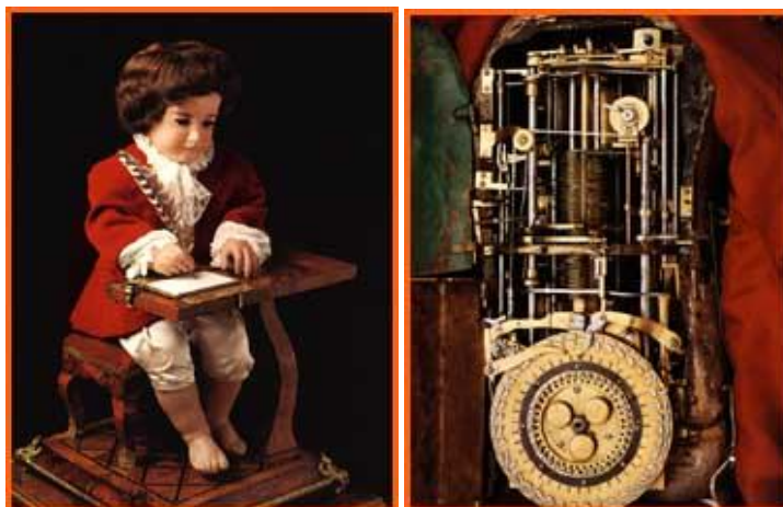
Obrázek 1.1 První android spisovatel (vlevo) a jeho vnitřní struktura (vpravo)
