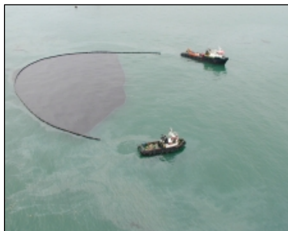
Obr. 7 Ohraničení a zmenšování ropné skvrny pomocí norné stěny
