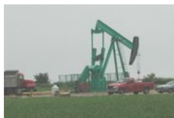
Obr. 2 Čerpání ropy pomocí pumpy
