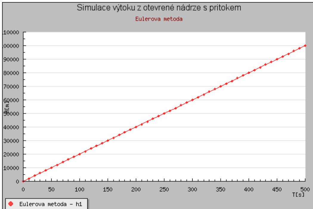
Obrázek 6.5: Odhad doby ustálení – model se neustálí v reálném čase
