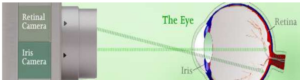
Obr. 16. Princip snímání oční sítnice a duhovky.
