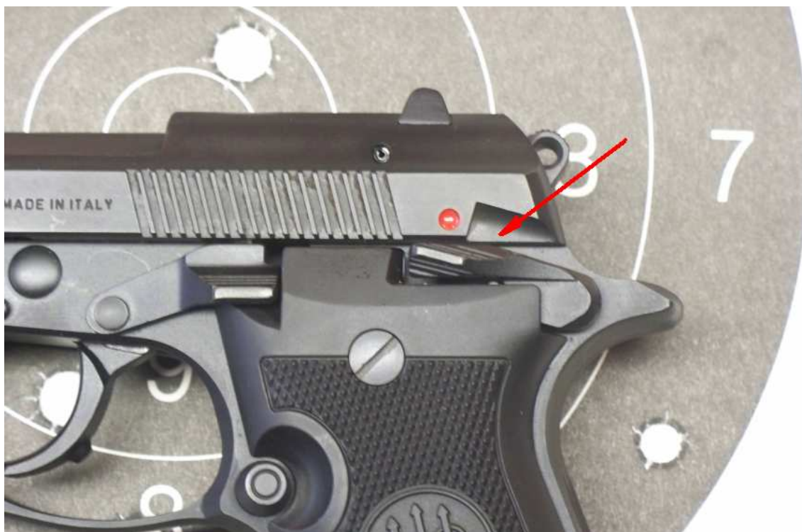
Obr.12 – Manuální pojistka v odjištěném stavu
