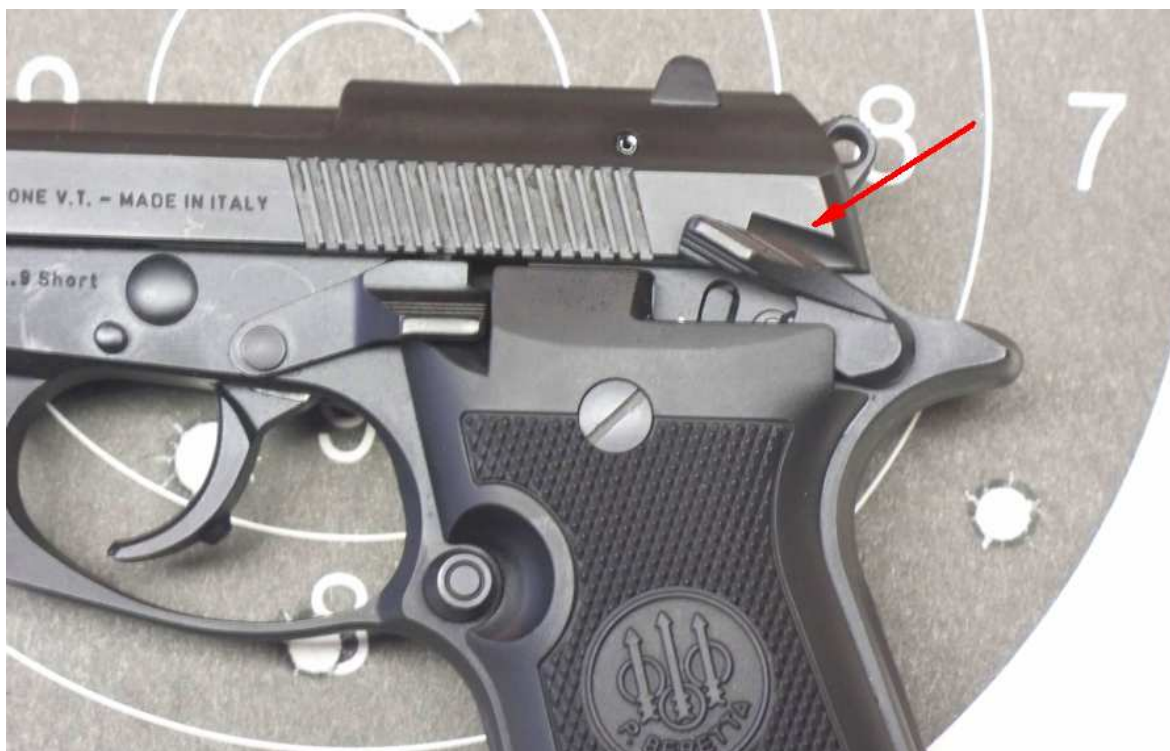
Obr.13 – Zajištěná zbraň manuální pojistkou
