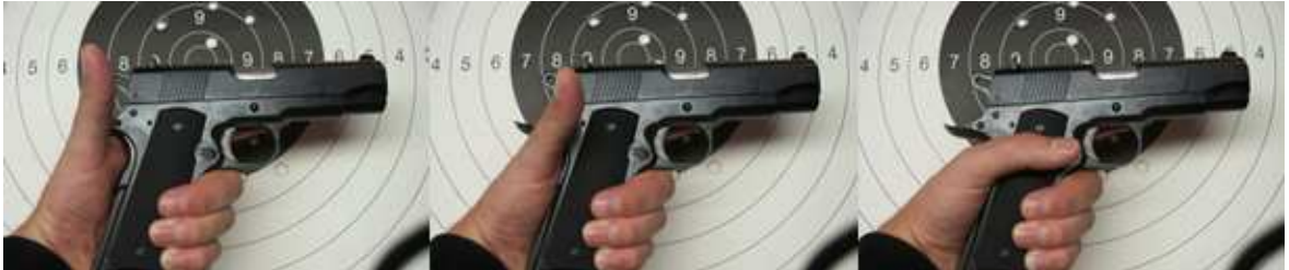
Obr.20 – Odjištění dlaňové pojistky
