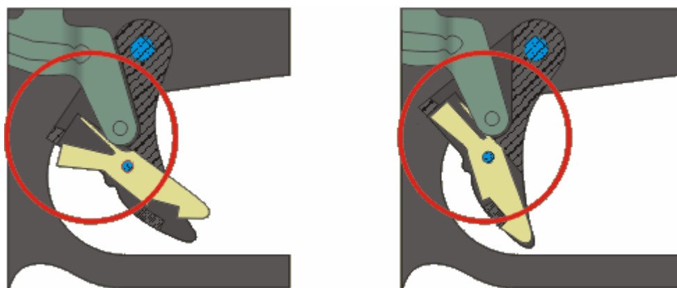
Obr.2 – Pojistka spouště v zajištěném a odjistěném stavu u pistole GLOCK
