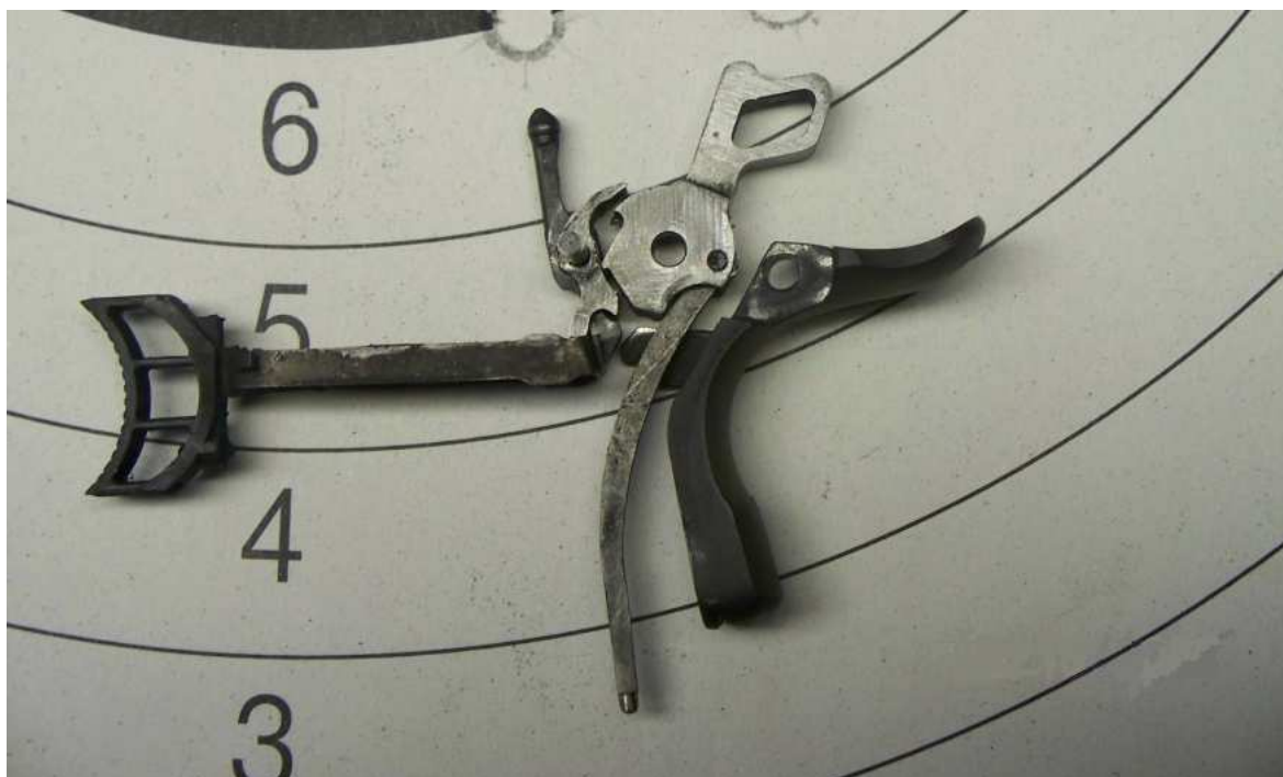
Obr.19 – Dlaňová pojistka v rozebraném stavu
