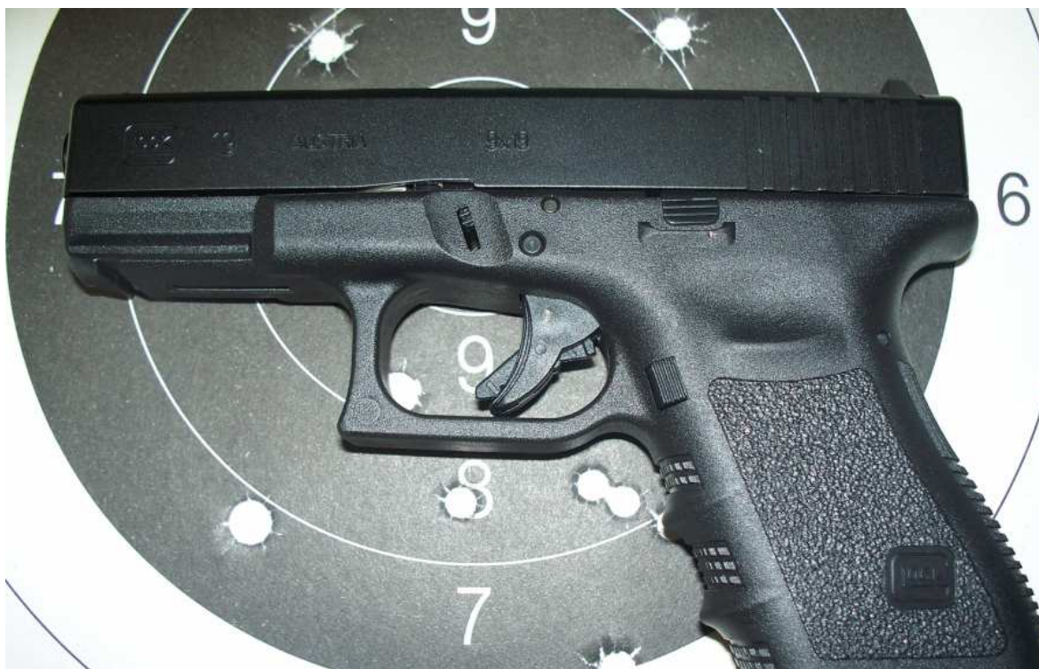
Obr.14 – Pojistka u zbraně GLOCK
