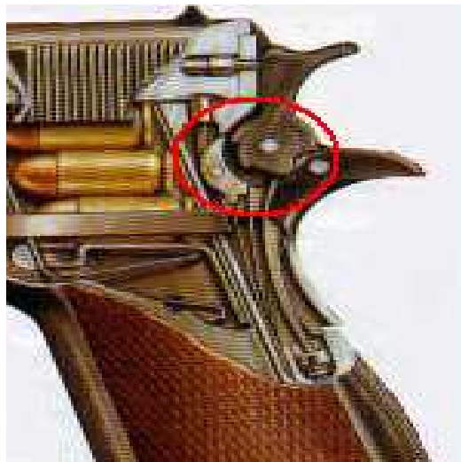
Obr.6 – Kohout s bezpečnostním ozubem u SIG Sauer P226
