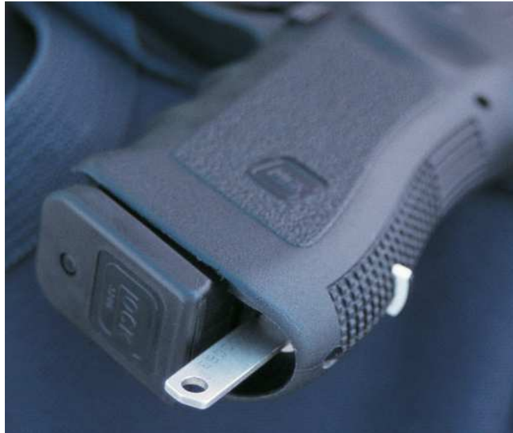
Obr.25 – Zámkový mechanismus u GLOCKa
