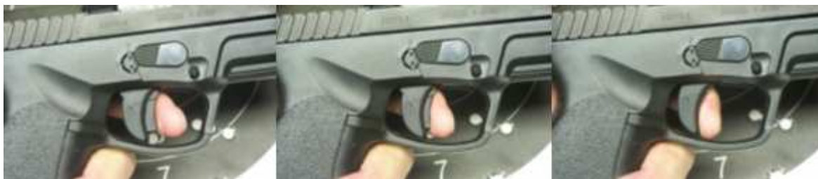
Obr.15 – Znáznornění odjištění pojistky
