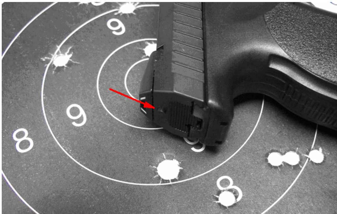
Obr.17 – Signalizace náboje v komoře, výstražník vystupující z obrysu zbraně
