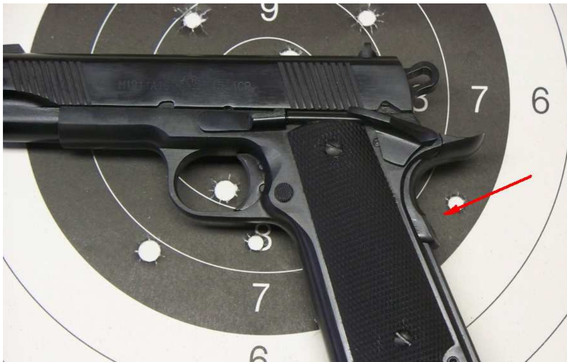
Obr.18 - Dlaňová pojistka u COLTu 1911
