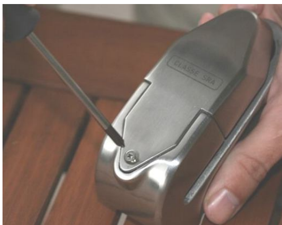
Obr. 11. Demontáž zadního krytu zámku pro výměnu baterií.
