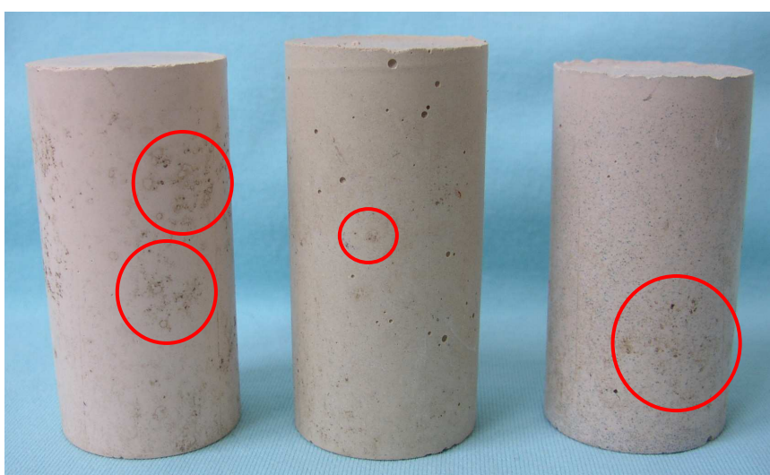
Obr. 20. Vzorky, které byly umístěny v půdním prostředí po dobu 63 dnů (zleva standard, vzorek A, vzorek B)
