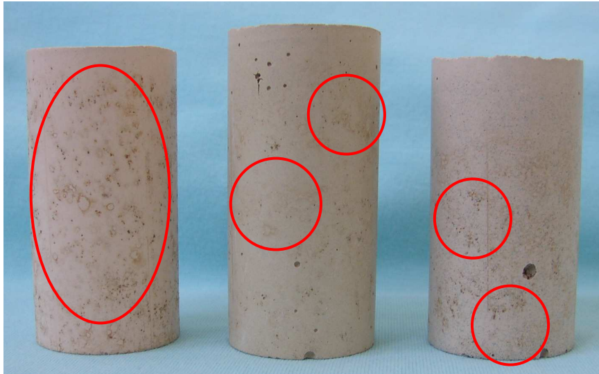
Obr. 22. Vzorky, které byly umístěny v půdním prostředí po dobu 105 dnů (zleva standard, vzorek A, vzorek B)
