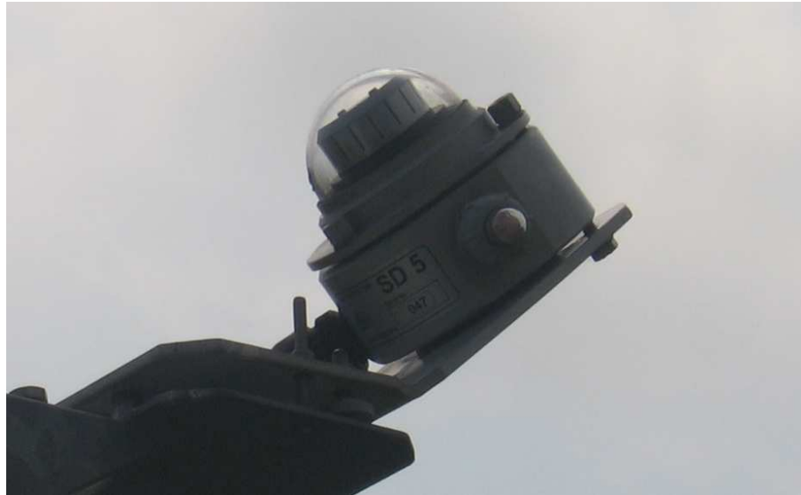
Obr. 7 – Elektronický heliograf na meteorologické stanici v Holešově
