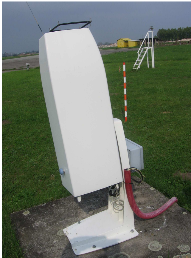
Obr. 2 – Ceilometr na meteorologické stanici v Holešově
