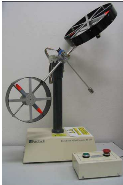
Obr. 9 Model „vrtulníku” 33-007 Twin Rotor MIMO Systém Feedback
