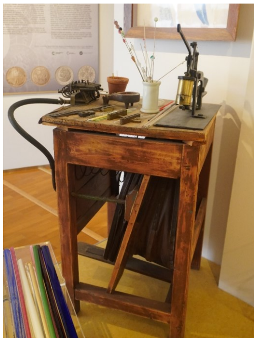
Obrázek 23 Historický kahan se šlapacím měchem v Muzeu skla a bižuterie v Jablonci nad Nisou
