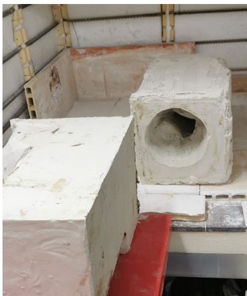
Obrázek 76 Forma na tavenou plastiku vložená do pece na vysušení
