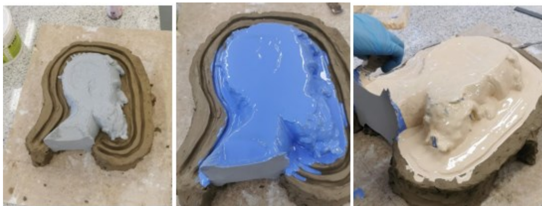
Obrázek 71 Průběh výroby lykopenové formy.
