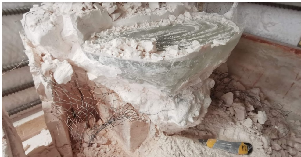
Obrázek 90 Čištění tavené plastiky přímo v peci.
