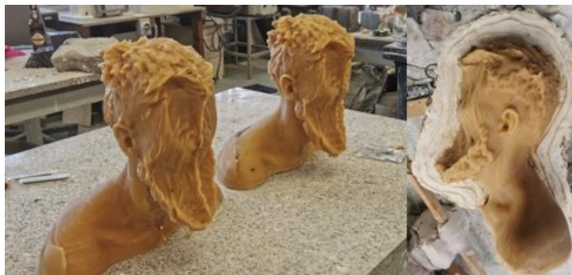
Obrázek 87 Parařinové odlitky vlevo, vyndávání parařinového odlitku z lukoprenové formy.
