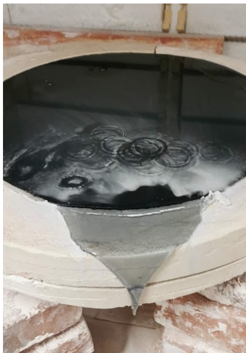
Obrázek 97 Dokončený proces tavení s přetokem skloviny.
