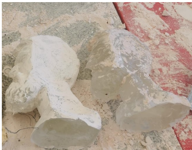
Obrázek 81 Neočištěné tavené plasty vyjmuty z formy.
