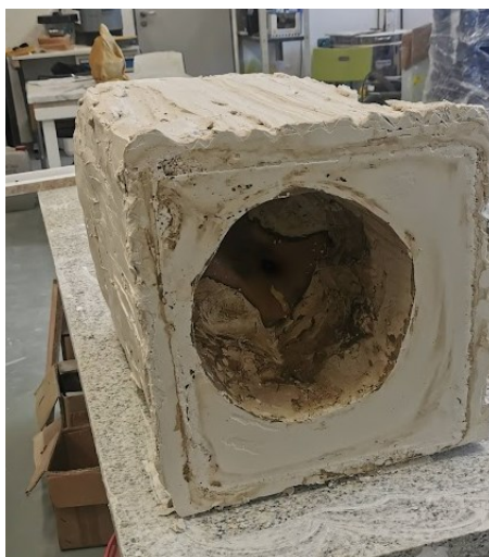
Obrázek 75 forma na tavenou plastiku ze spodu po odstranění hlíny.
