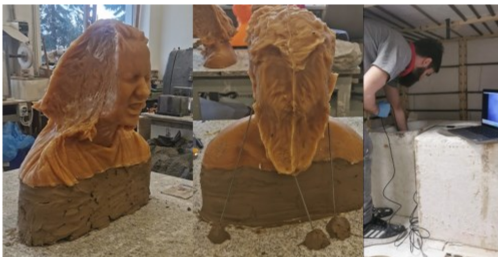
Obrázek 88 Model neurotika a světloplachosti s hliněnou násypkou vlevo, kontrola forem endoskopovou kamerou vpravo.
